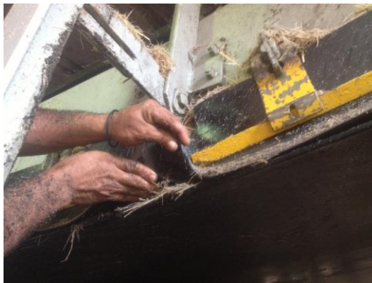
Figura No. 5 Nivel de bagazo acumulado adecuado y no adecuado en el área de los selladores de la banda del Tándem B
