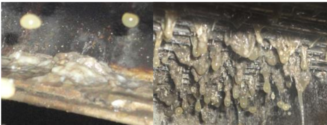
Figura 15. Polisacárido encontrado en colador de tanque de jugo diluido del tándem B.
