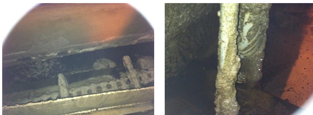
Figura 50. Presencia de material acumulado en el tándem B del Ingenio Pantaleón.FECHA: 21 MARZO 2013
