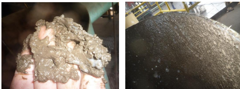
Figura 44. Presencia de biopelículas acumuladas en el tanque de jugo cristal en el tándem B del Ingenio Magdalena encontrado al vaciarlo durante mantenimiento. FECHA: 1 FEBRERO 2013
