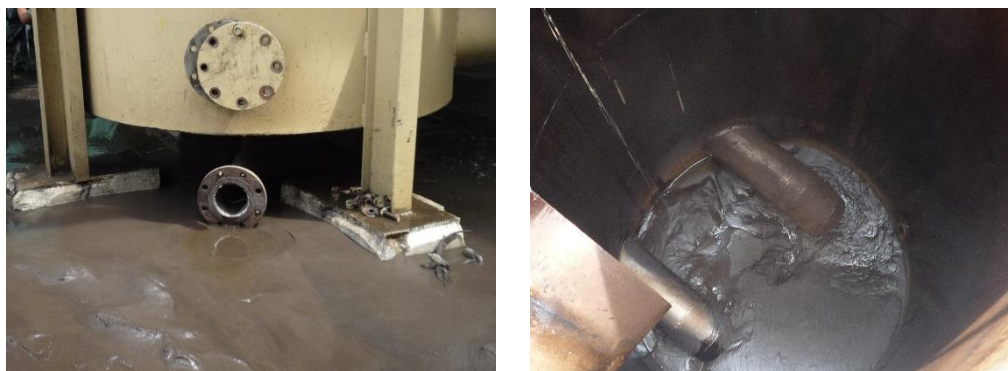
Figura 46. Presencia de biopelículas acumuladas en tanque de jugo cristal en el tándem C del Ingenio Magdalena.FECHA: 8 FEBRERO 2013
