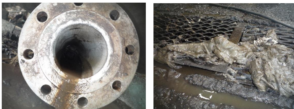
Figura 44. Presencia de biopelículas acumuladas en el tanque de jugo cristal en el tándem B del Ingenio Magdalena encontrado al vaciarlo durante mantenimiento. FECHA: 1 FEBRERO 2013
