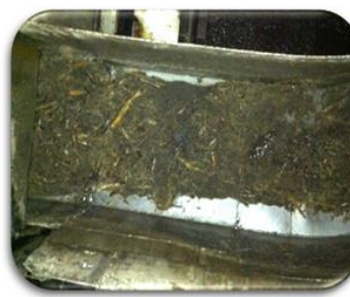
2. Bagazo estancado en conductor del tándem A
