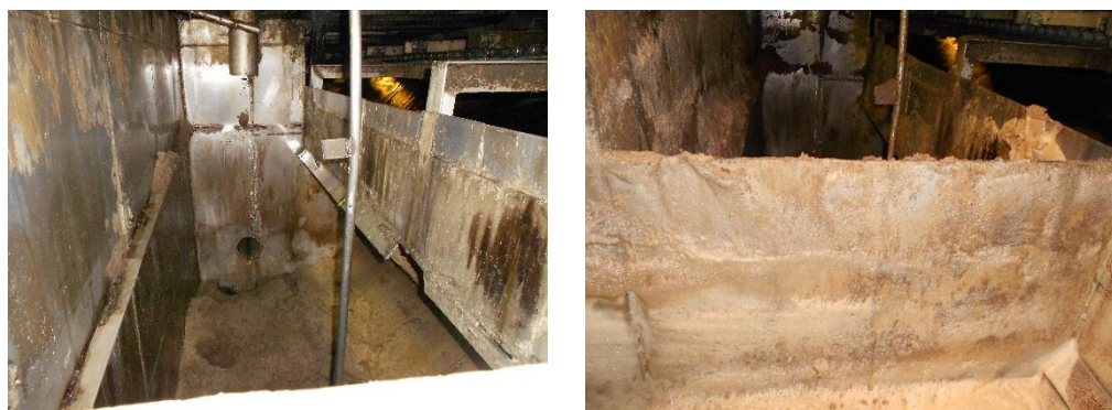
Figura 49. Material acumulado y presencia de biopelículas en el tándem A del Ingenio Pantaleón.FECHA: 12 MARZO 2013
