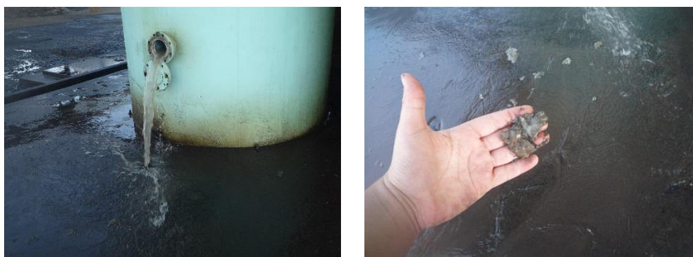
Figura 47. Presencia de material acumulado en taque de jugo mezclado en el tándem C del Ingenio Magdalena.FECHA: 8 FEBRERO 2013
