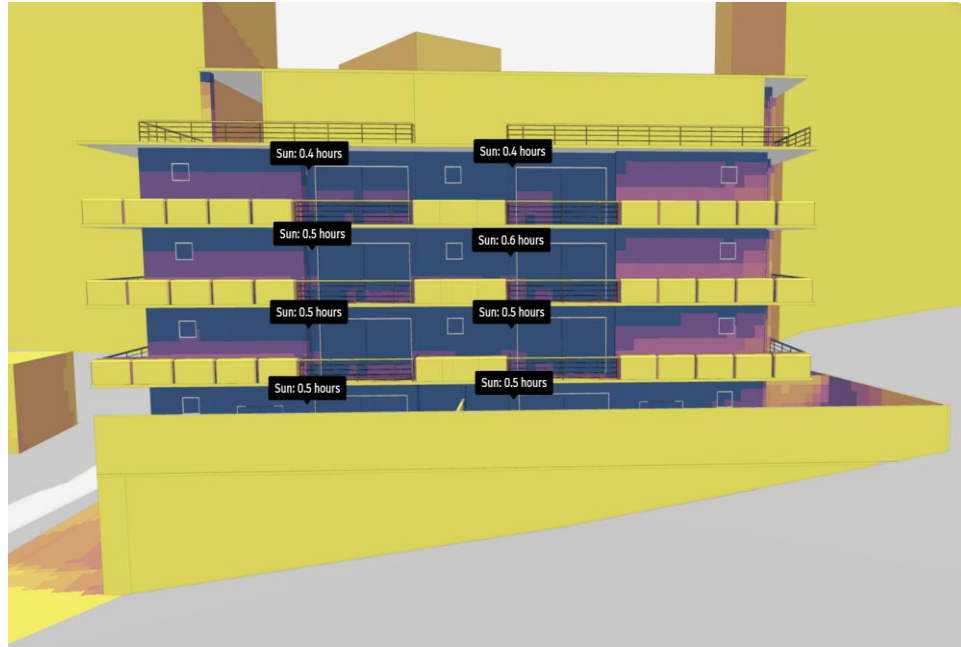
Figura No. 28: Sun Hours (solsticio de verano) – Elevación Sur Fuente: Elaboración propia.
