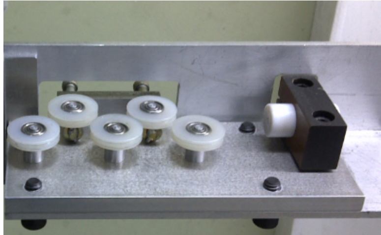
Figura 17. Guia de alambre adaptado a estructura del tren de poleas
