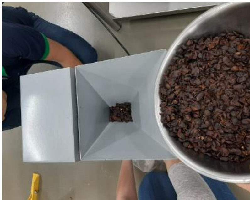
Figura 43. Proceso de molienda de pulpa de café maduro deshidratado ( Coffea arábica , bourbon)
