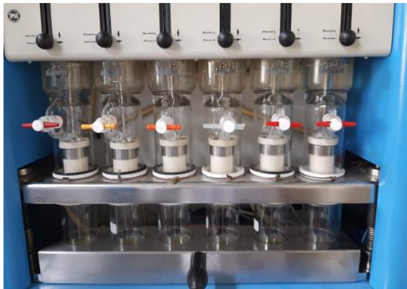
Figura 39. Proceso de cuantificación de grasa de las muestras de café ( Coffea arábica, bourbon ) en diversas etapas del proceso
