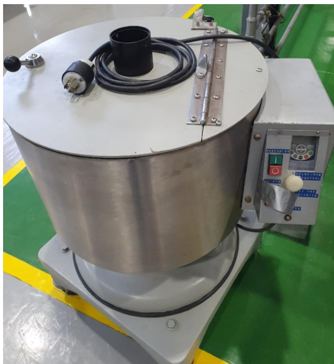
Figura 21. Tamizadora marca W.S. Tyler, Modelo RX-29
