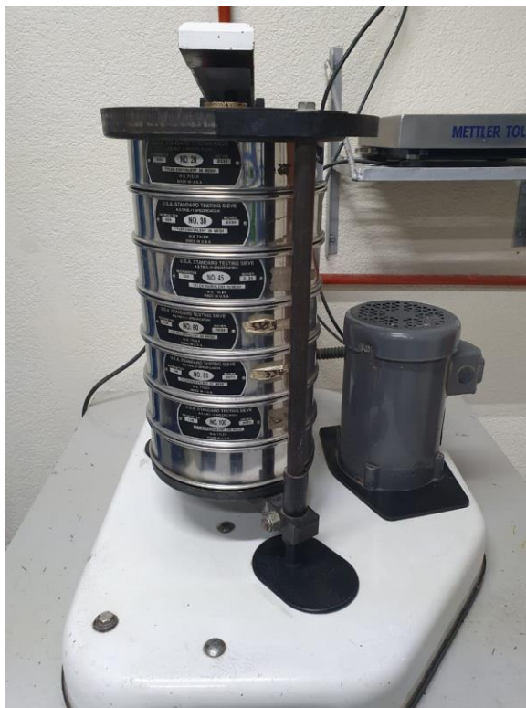
Figura 21. Tamizadora marca W.S. Tyler, Modelo RX-29
