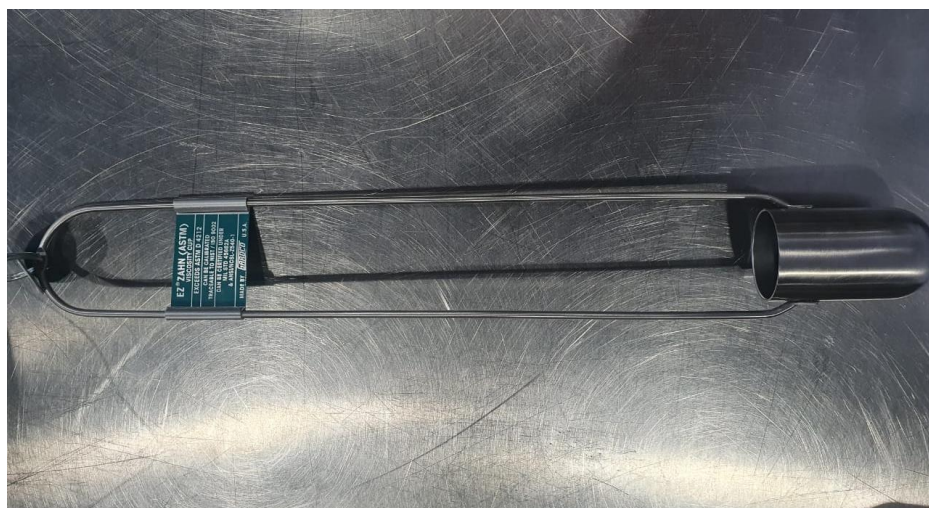
Figura 19. Viscosímetro marca Ez Zahn
