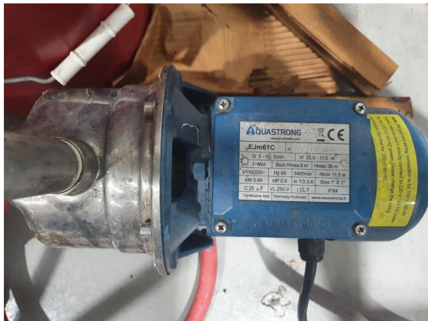
Figura 23. Bomba centrífuga de 0.45 kW marca Aquastrong
