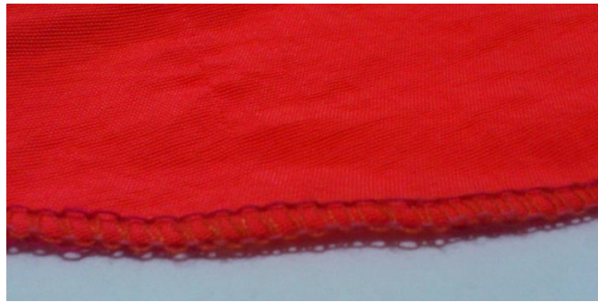
Figura 64. Refuerzo realizado a la membrana en zona de unión a la estructura
