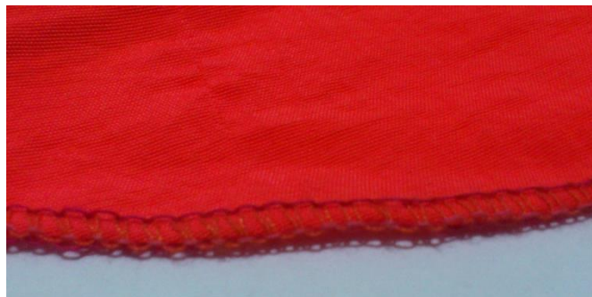
Figura 84. Refuerzo realizado a la membrana en la zona de unión a la estructura
