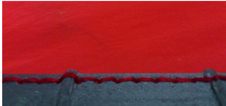
Figura 62. Resultado del sistema de sujeción de la membrana al Aerobrake (Resultado final)
