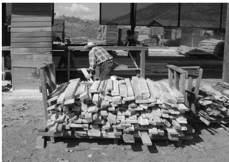
Figura 910. “Leña” proveniente de la despuntadora del aserradero No. 2 - útil para finger joint
