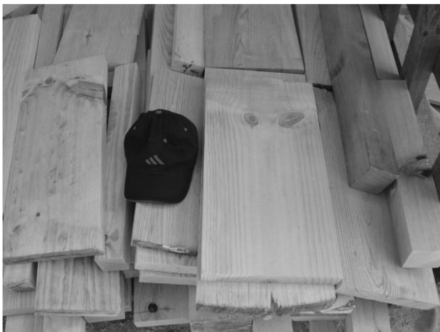
Figura 9.7 Leña de despuntadora del área de cepillo - útil para finger joint
