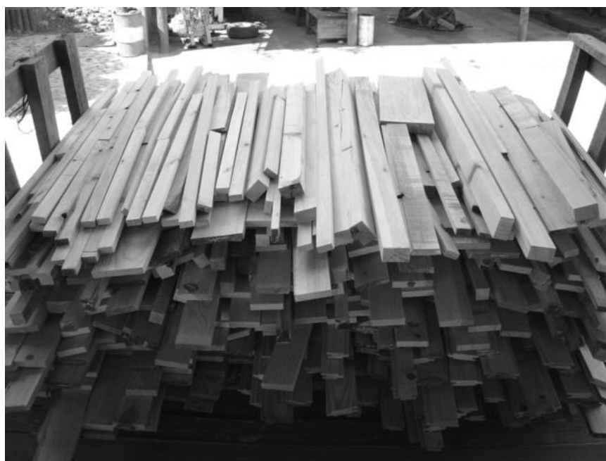
Figura 910. “Leña” proveniente de la despuntadora del aserradero No. 2 - útil para finger joint
