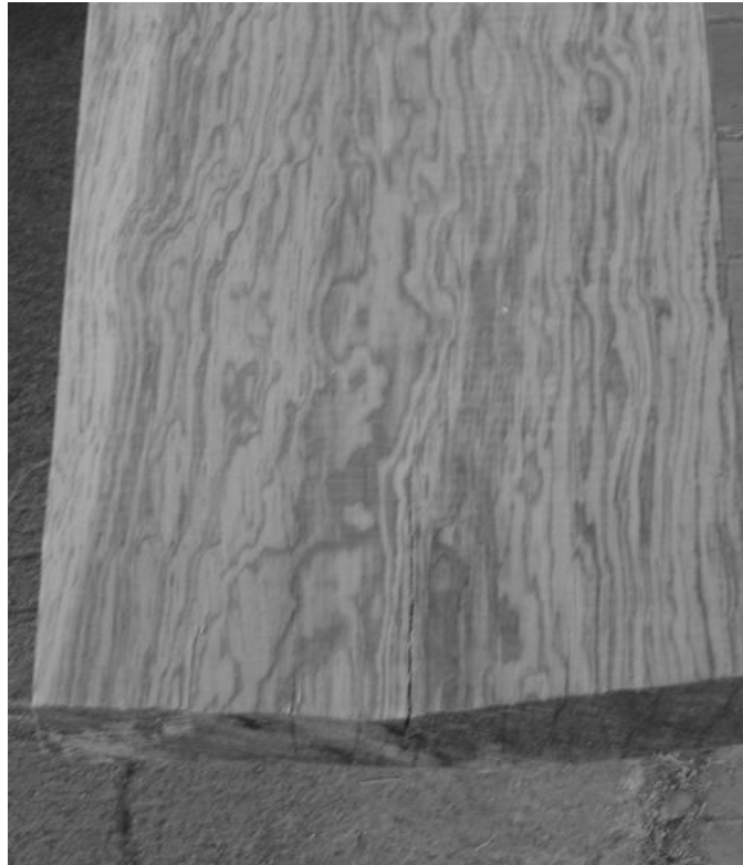
Figura 9.4 Madera ocotosa – no útil para finger joint
