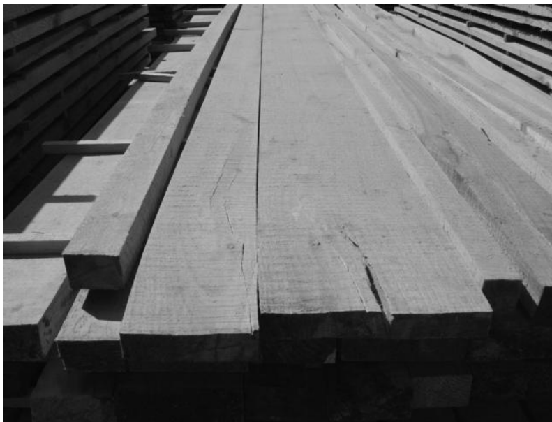
Figura 9.2. Madera de tercera con rajaduras
