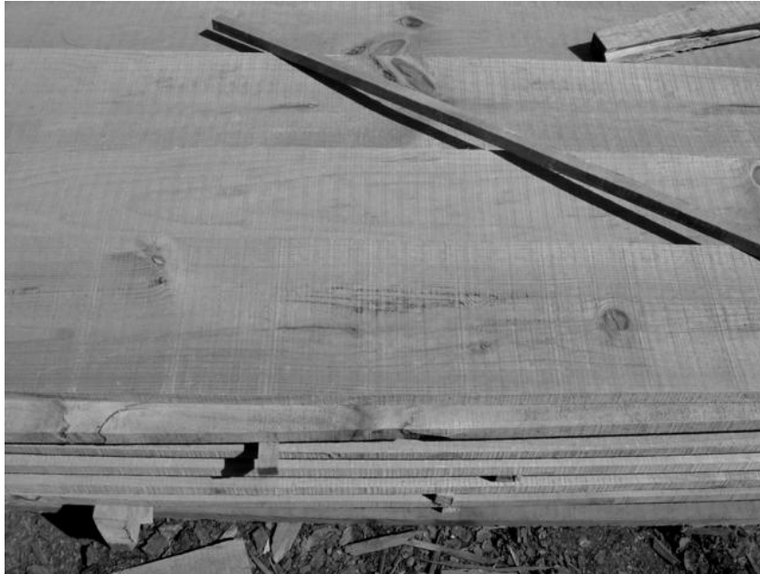
Figura 9.3. Secciones nudosas de madera de tercera
