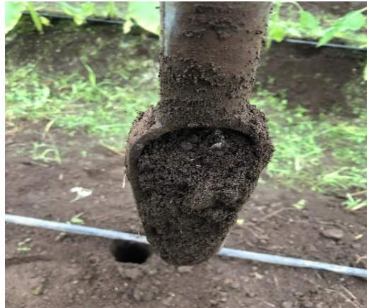
Figura 24. Extracción de submuestras de suelo
