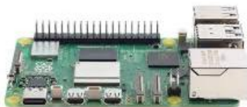
Figura 3. Raspberry Pi 5 utilizada como servidor educativo
