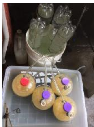
Figura 104: Montaje de digestores y trampa de gas
