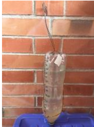
Figura 101: Construcción de trampa de biogás
