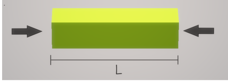
Figura 5: Sección sometida a compresión
