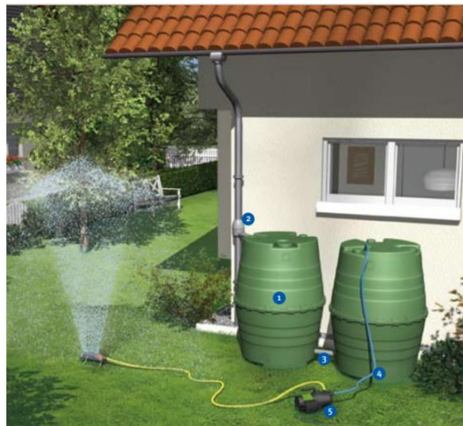
Figura 27. Tanques de almacenamiento prefabricados.
