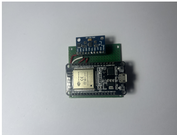
Figura 23: Placa de prototipo para obtención de datos de unidad de medición inercial
