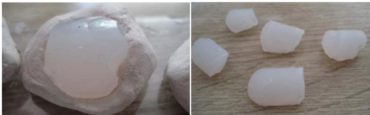
Figura 132. Fabricación de yemas de dedos con silicona sellante transparente
