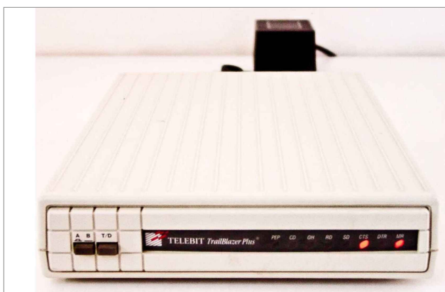
Figura 6. Módem Telebit Trailblazer utilizado para conectar la computadora a la red telefónica, en la primera conexión al Internet desde Guatemala.
