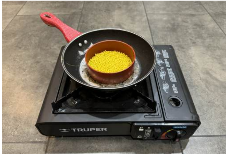
Figura 5: Pellets de HDPE, colocación adecuada para fundición
