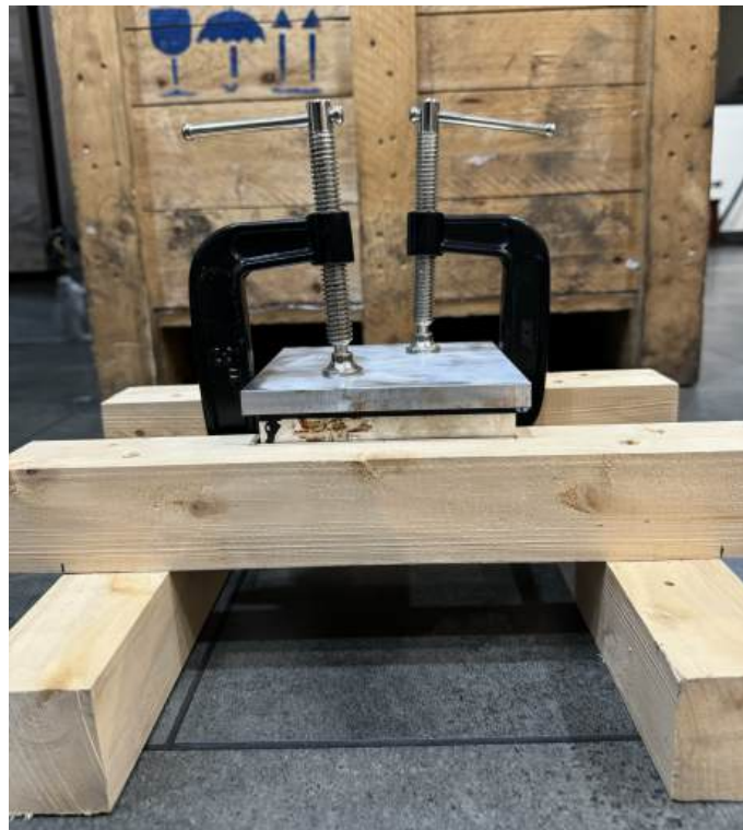
Figura 36: Enfriamiento del molde de aluminio
