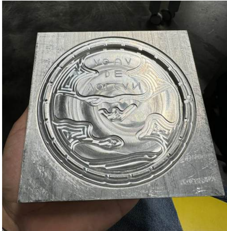
Figura 26: Molde aluminio 6061 maquinado
