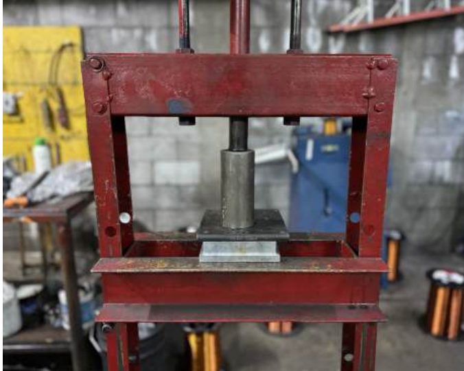
Figura 39: Presión ejercida en molde
