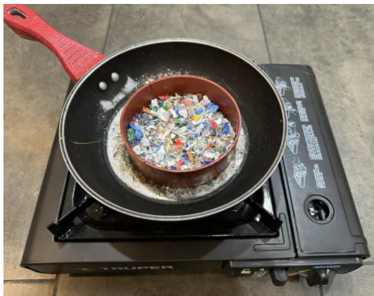
Figura 6: Sistema de fundición, con tapas plásticas trituradas
