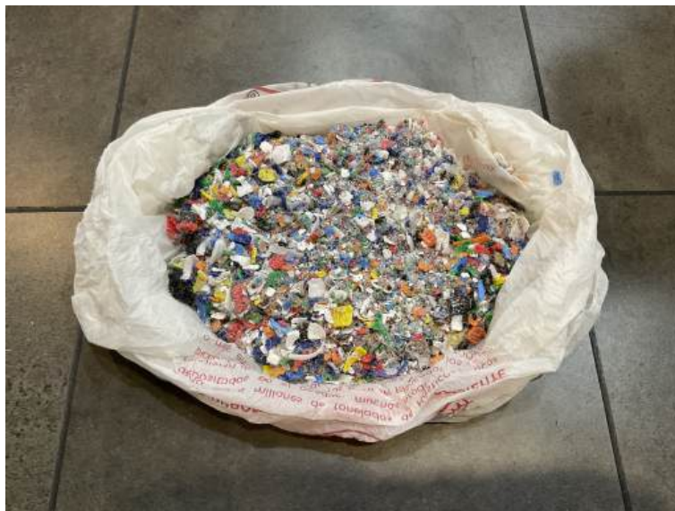
Figura 4: Pellets triturados de tapas de botellas
