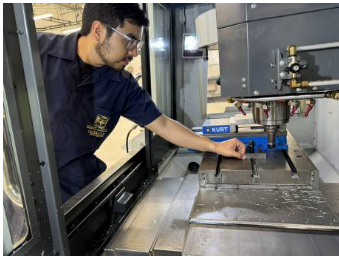
Figura 25: Medición de la altura de la herramienta de corte utilizando una alsa de 20mm.
