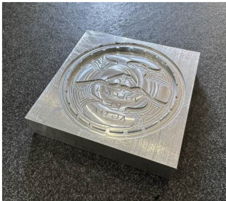
Figura 27: Molde aluminio 6061 maquinado vista lateral
