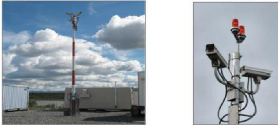
Figura 37. Cámara de clima (WCAM).
