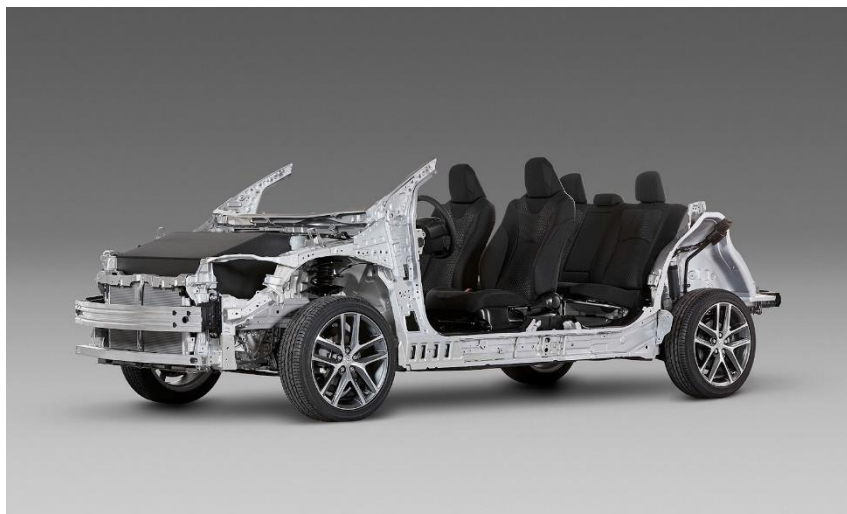
Figura 54. Plataforma modular TNGA
