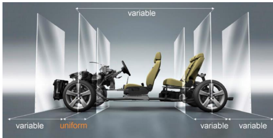
Figura 55. Plataforma modular MQB
