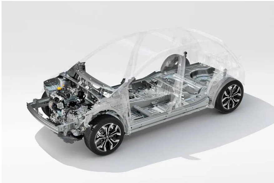
Figura 56. Plataforma modular CMF
