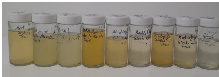
Figura 33 Imagen de varios medios de cultivo con modificación en la concentración de fósforo y magnesio sin inocular
