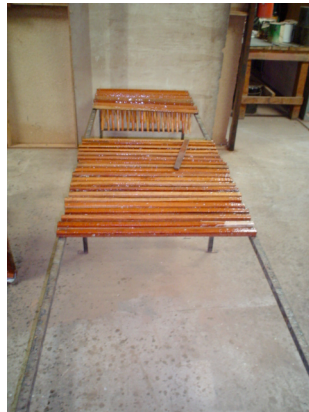
Fotografía #8: Sistema par sellar, barnizar y secar la madera
