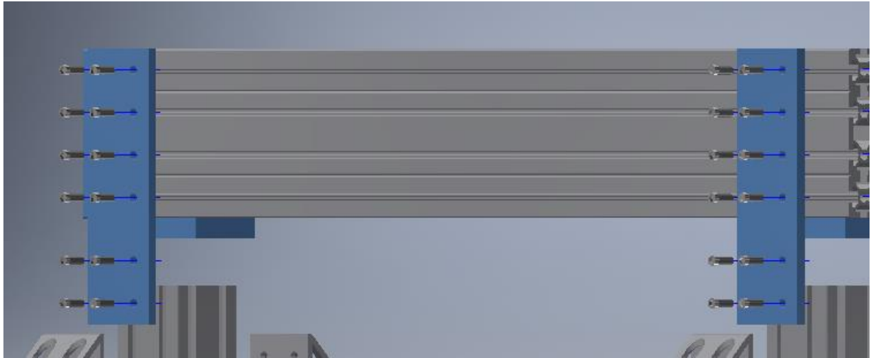
Figura 7: Tornillos M5 para plates de unión de perfiles de aluminio 80x40.
