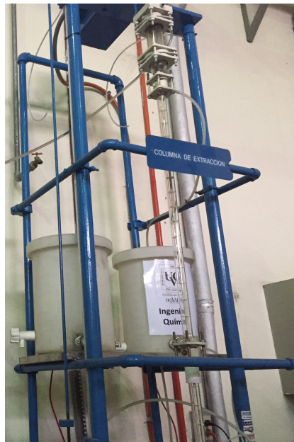
Figura 9. Columna de extracción del Laboratorio de Operaciones Unitarias.
