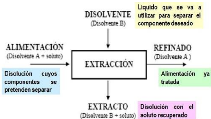
Figura 1: Proceso idealizado de la extracción líquido-líquido.
