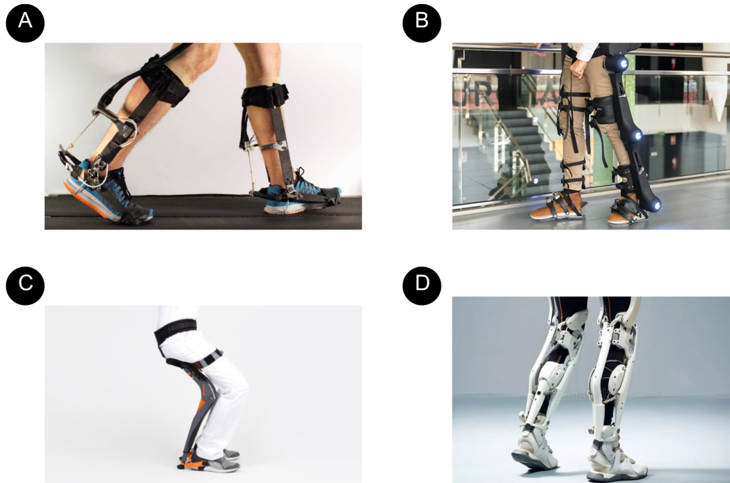
Figura 7. Ejemplos de exoesqueletos de pierna aplicados a asistencia y rehabilitación de la marcha. A) Exoesqueleto pasivo adaptable. B) Exoesqueleto para rehabilitación de marcha. C) Exoesqueleto tipo “ chairless chair ”. D) Exoesqueleto robótico de pierna [31] [32] [33]
