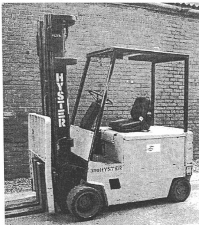
Fotografía # 6: Montacargas eléctrico
