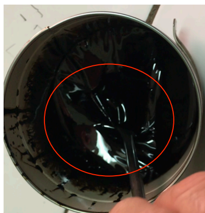
Imagen No. 13 Resultados de prueba de calor de la unión de bitumen con DPET.
