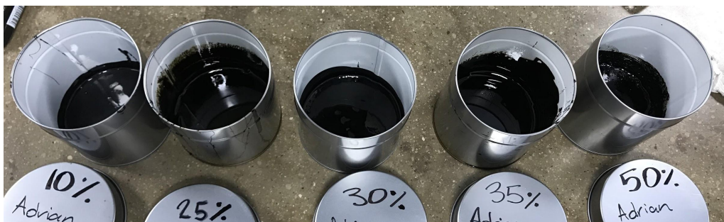
Imagen No. 12 Unión del bitumen con DPET en diferentes porcentajes almacenadas en contenedor de aluminio.
