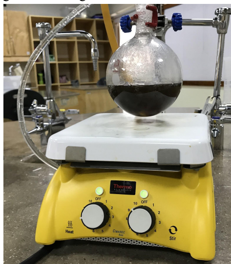
Imagen No. 4 Degradación en sistema de reflujo
