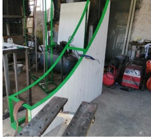
Ilustración 87 Cortes y colocación de paneles de aislamiento térmico
