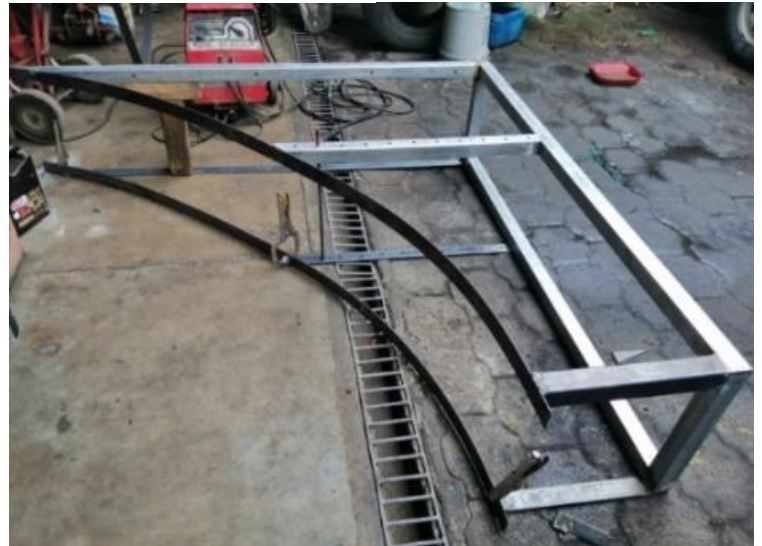
Ilustración 76 Moldeado y soldadura de curva de difusor
