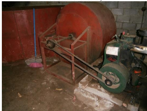
Ilustración 9 Unidad de potencia (Motor-Ventilador= de Secador circular)
