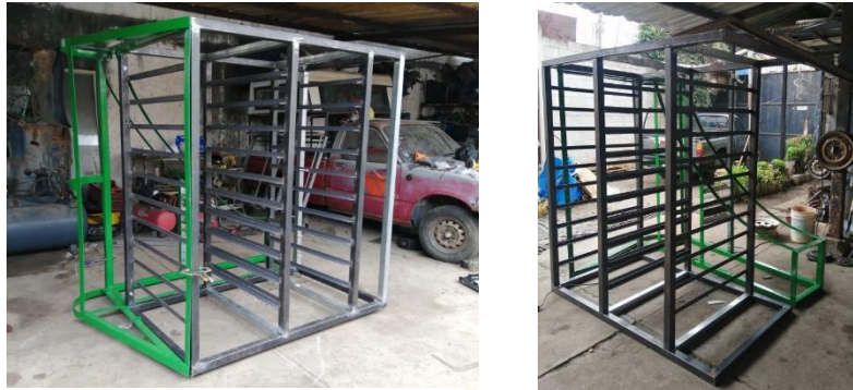
Ilustración 86 Ensamble de estructuras para perforación de agujeros de acoplamiento
