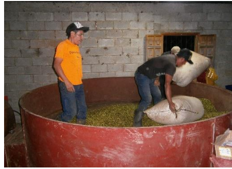
Ilustración 14. Carga y uniformizado de capa de cardamomo en secador circular.
