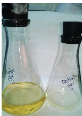
Ilustración 15: Destilados y colas, experimentación éter
