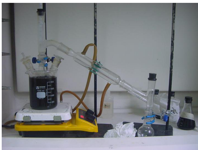
Ilustración 7: Sistema de destilación simple, en campana de extracción
