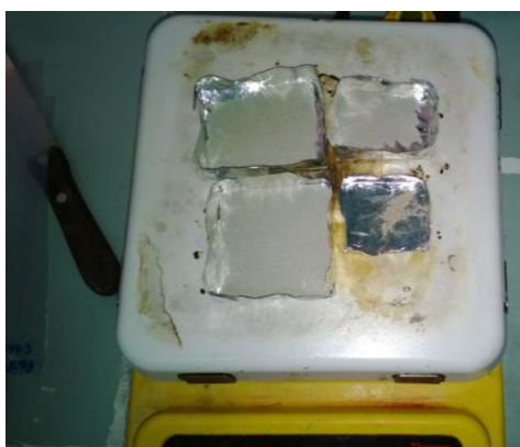
Ilustración 17: Secado de catalizador en bandejas de papel aluminio
