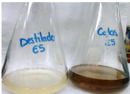
Ilustración 13: Destilados y colas de la primera destilación, experimentación 5
