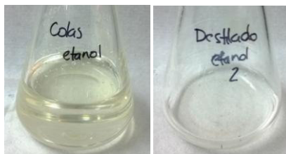
Ilustración 16: Colas y destilados, obtenidos de la experimentación con etanol
