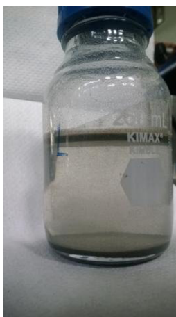
Ilustración 9: Muestra de la separación con la técnica sink-float
