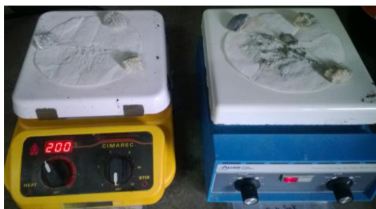
Ilustración 18: Secado de solventes en papel filtro
