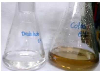
Ilustración 11: Destilado y colas obtenidos de la primera destilación de la experimentación 4
