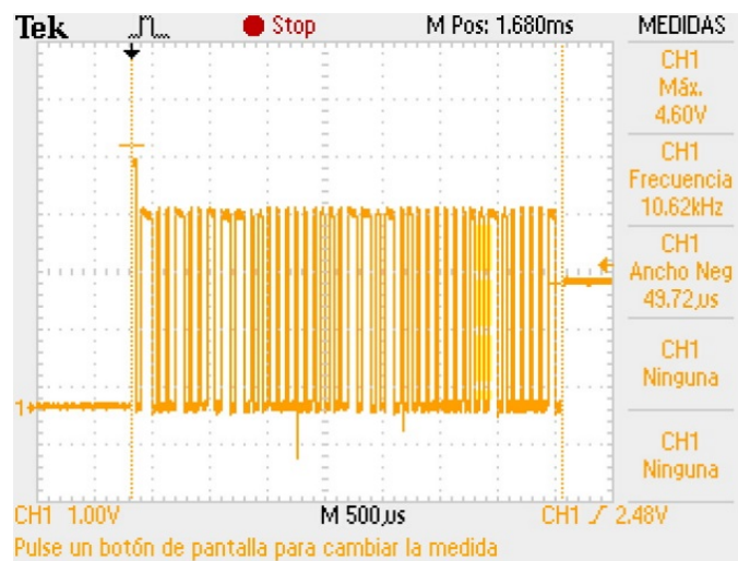
Figura 96. Señal de datos del sensor DHT11
