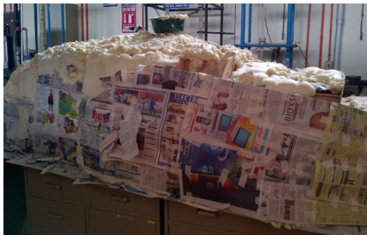
Figura 43. Molde para carrocería terminado
