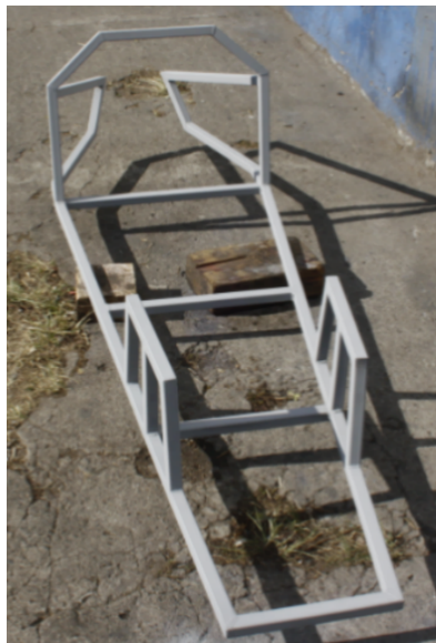
Figura 32. Prototipo fabricado con tubería cuadrada de hierro negro
