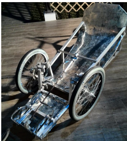
Figura 37. Chasis con sillón y mamparo instalados
