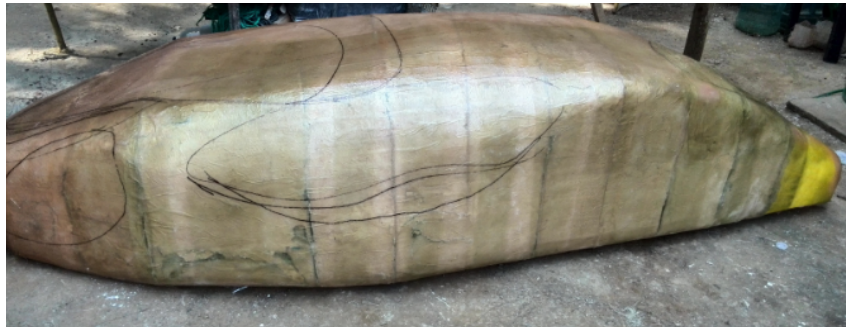
Figura 44. Carrocería con marcas para cortes de ventanas
