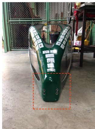
Figura 163. Sensores ultrasónicos montados sobre el vehículo
