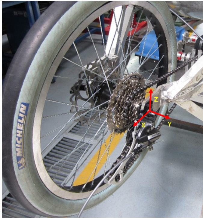
Figura 143. Disposición de ejes para análisis de falla en soporte trasero
