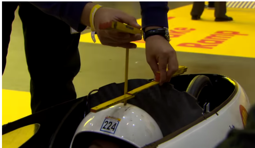
Figura 150. Medición de altura mínima
