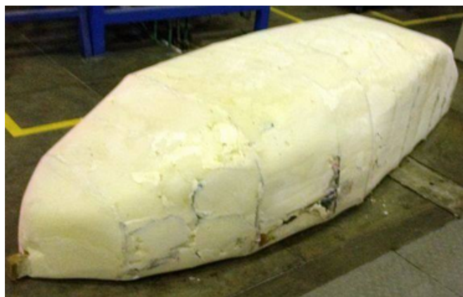
Figura 43. Molde para carrocería terminado
