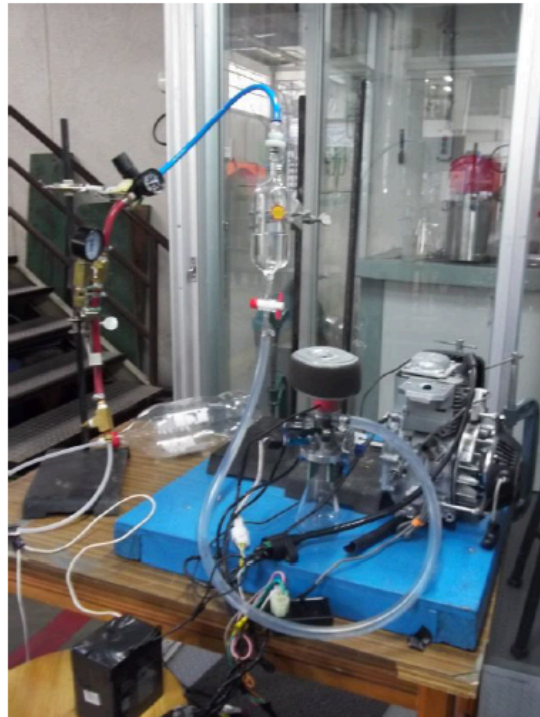
Ilustración 2: banco de pruebas calibración de masa de combustible inyectado
