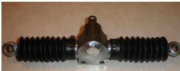
Figura 172. Mecanismo engrane y piñón
