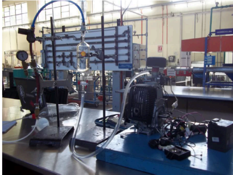
Ilustración 2: banco de pruebas calibración de masa de combustible inyectado
