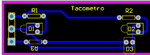
Figura 113. Diseño del circuito impreso del sensor infrarrojo
