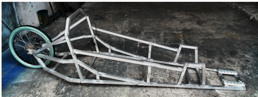
Figura 36. Chasis con soportes para otros sistemas soldados
