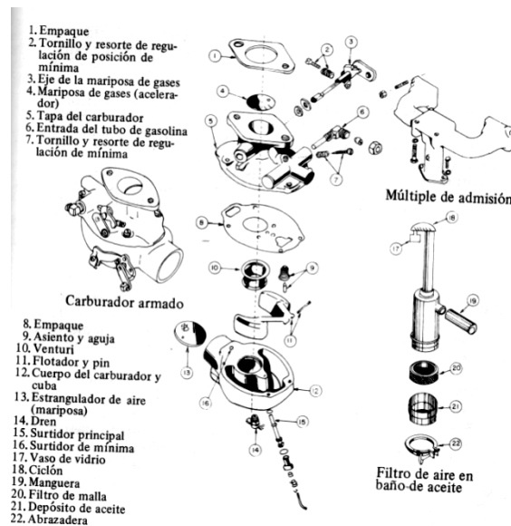
Figura 18. Partes de un carburador y filtro de aire
