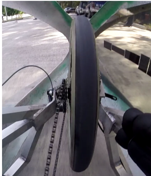
Figura 142. Desalineación de la llanta trasera, vista frontal
