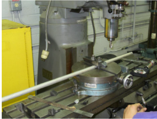
Figura 30. Proceso de fresado del equipo Panther Rage G2
