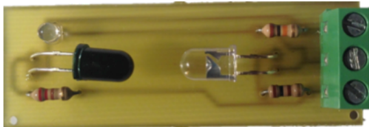
Figura 117. Circuito impreso del sensor óptico
