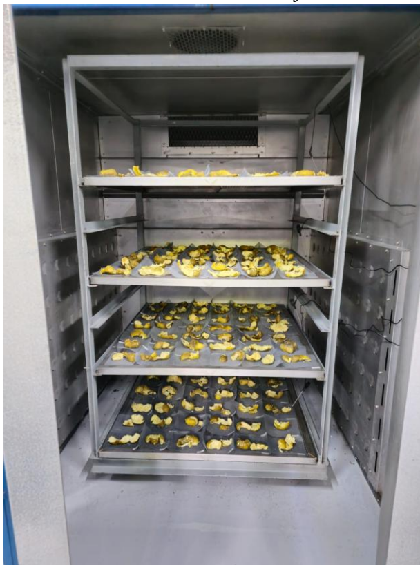
Figura 19. Colocación de limones en secador de bandejas.
