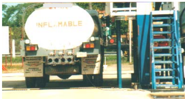
Foto No. 43: Camión conectado a tierra
