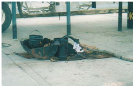
Foto No. 16: Cubeta plástica con bunker y desorden.
