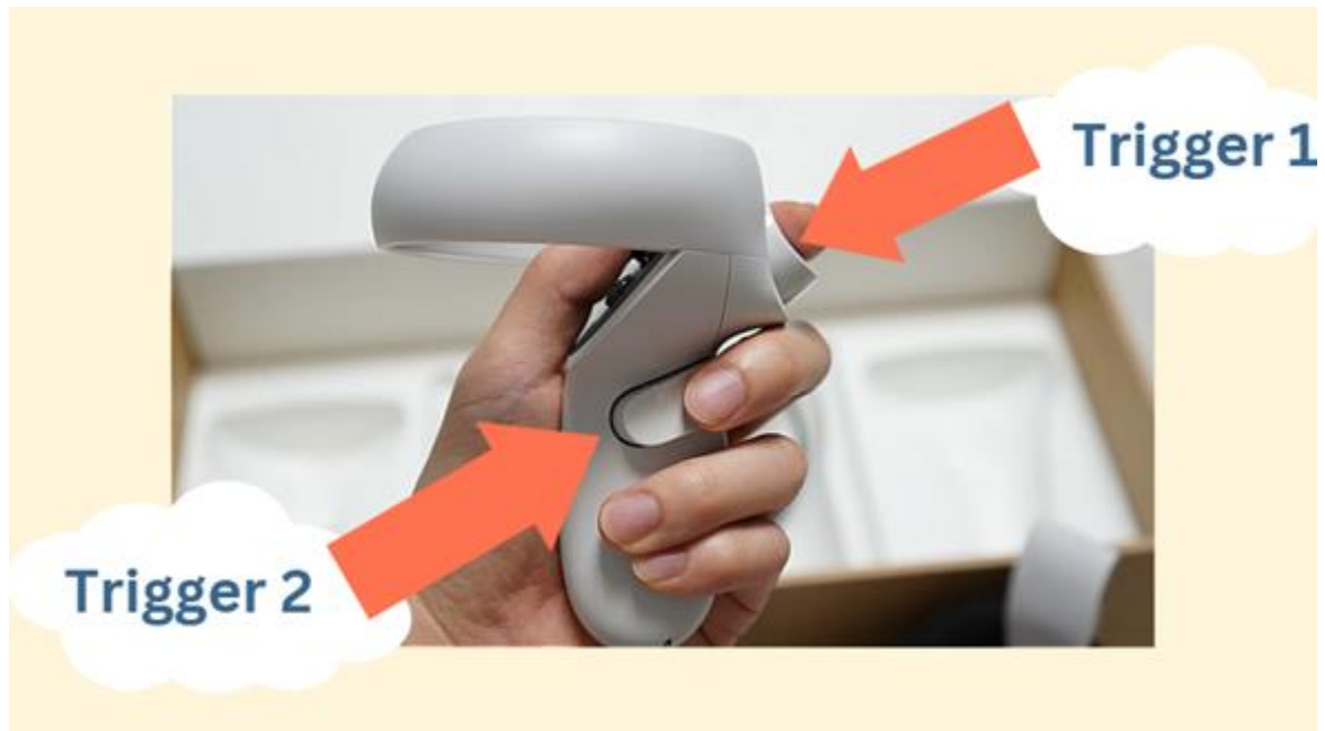
Figura 29. Señalamiento de controles 2
