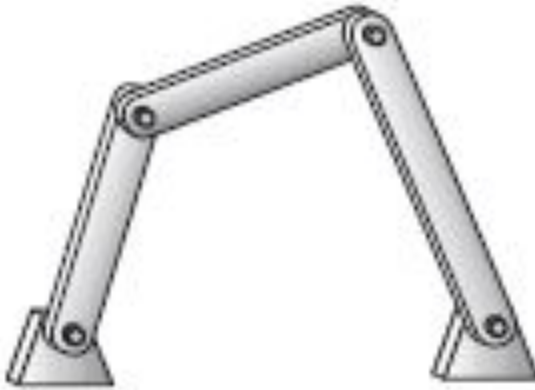
Figura 8: Mecanismo de cuatro barras de cadena cerrada
