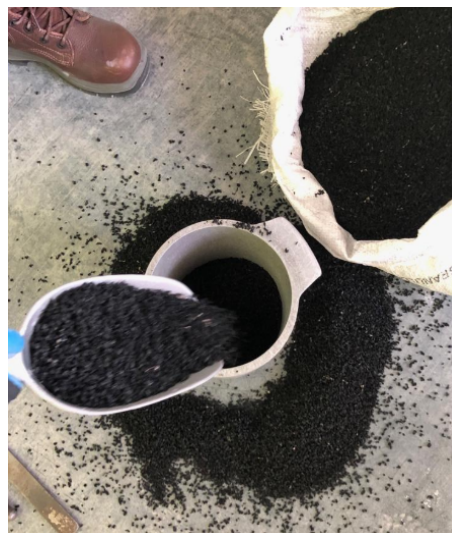
Figura 28: Caucho granulado, obtenido de RECIAVAN, S.A.
