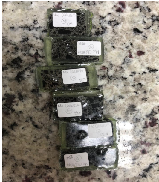
Figura 73: Secciones delgadas terminadas
