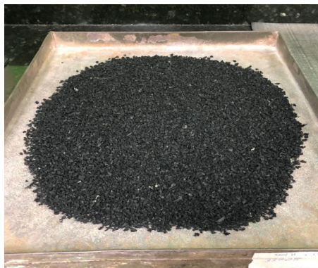
Figura 13: Caucho granulado, muestra de 300 gramos.
