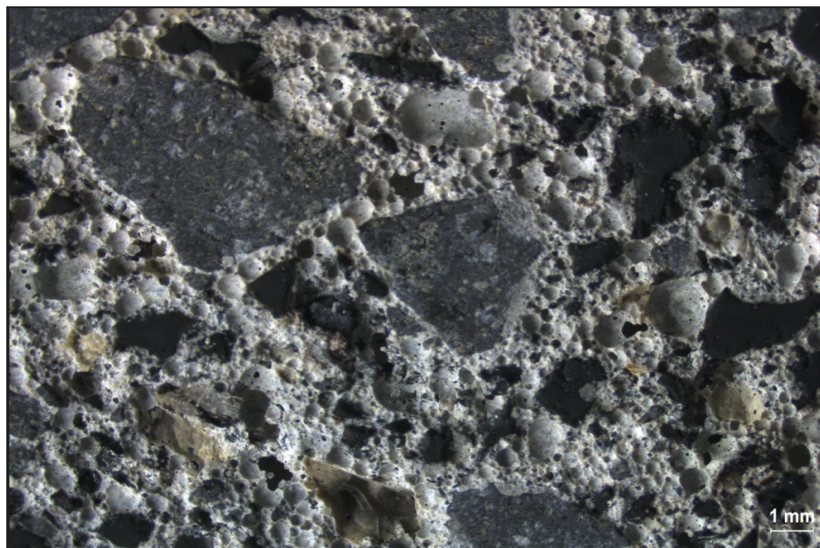
Figura 82: Imagen 10X de mezcla con sustitución de agregado fino por caucho granulado del 20 %
