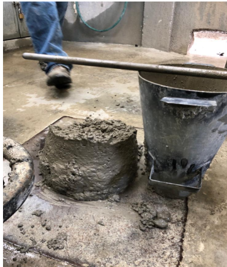
Figura 29: Determinación de asentamiento
