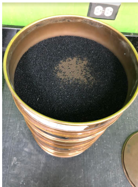
Figura 14: Proceso de tamizado
