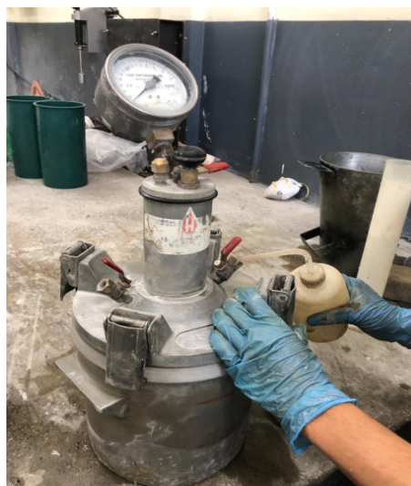
Figura 31: Determinación de contenido de aire
