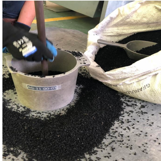
Figura 18: Varillado en capas
