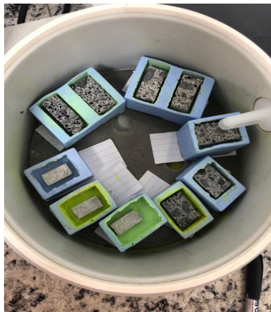
Figura 72: Aplicación de resina a muestras cortadas
