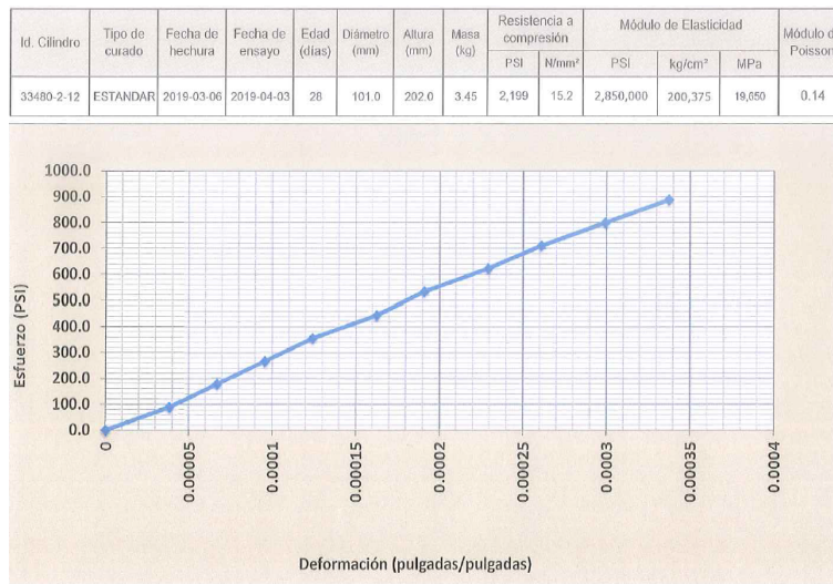
Figura 48: Gráfica de Esfuerzo vs. Deformación para mezcla de 10 % de sustitución, cilindro 2
