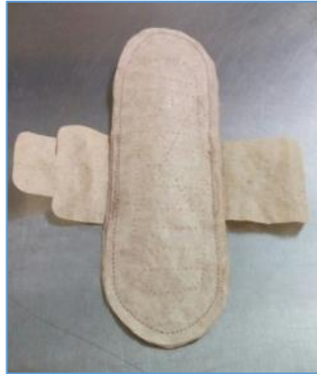
Figura 6. Toalla Sanitaria biodegradable. Fabricado en Laboratorio de Operaciones Unitarias Universidad del Valle de Guatemala.
