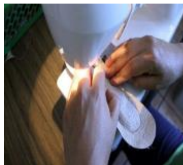
Figura 22. Punteado. Proceso elaboración de prototipo. Fabricado en Laboratorio de Operaciones Unitarias Universidad del Valle de Guatemala.
