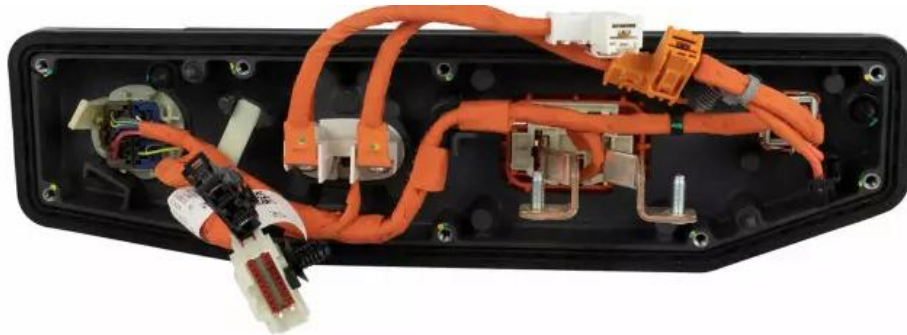
Figura 17. Placa de conectores para la caja de alto voltaje de la batería vista trasera
