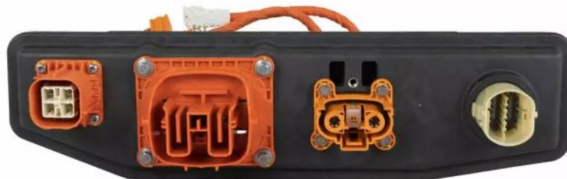
Figura 16. Placa de conectores para la caja de alto voltaje de la batería vista frontal
