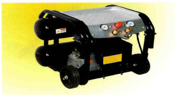
Fotografía 3: Compresor de aire
