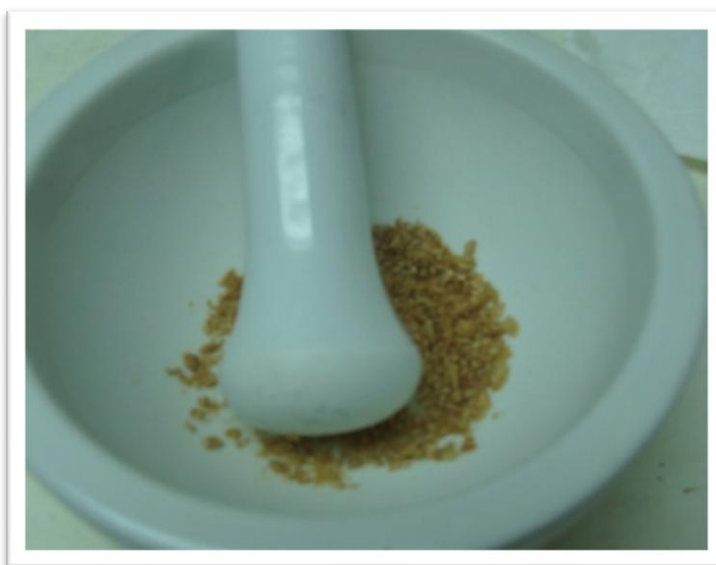
Figura No. 25: Trituración manual de la biomasa de Lipomyces Starkeyi obtenida del crecimiento en el fermentador de 5L con Caldo Sabouraud al 2% glucosa.
