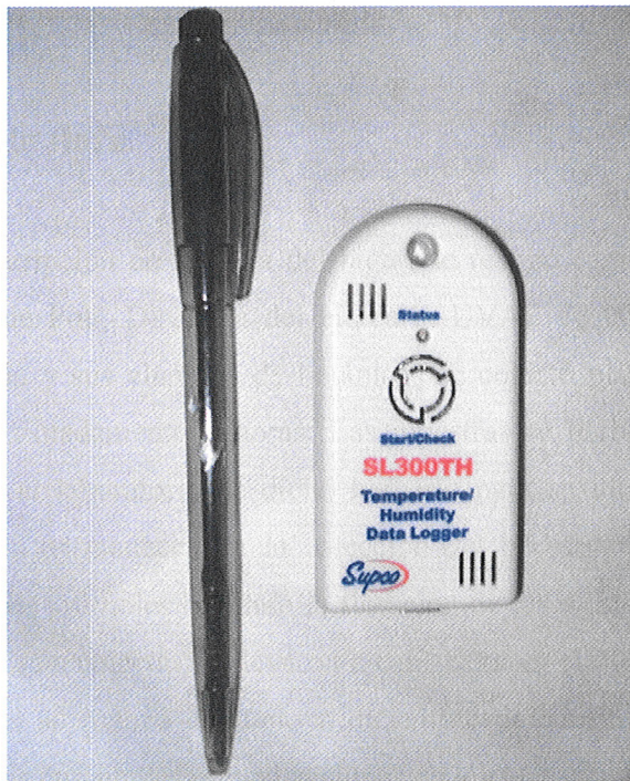
Figura 4. Muestra del tamaño del data logger. Este equipo se utilizó para monitorear temperatura, humedad relativa y punto de rocío
