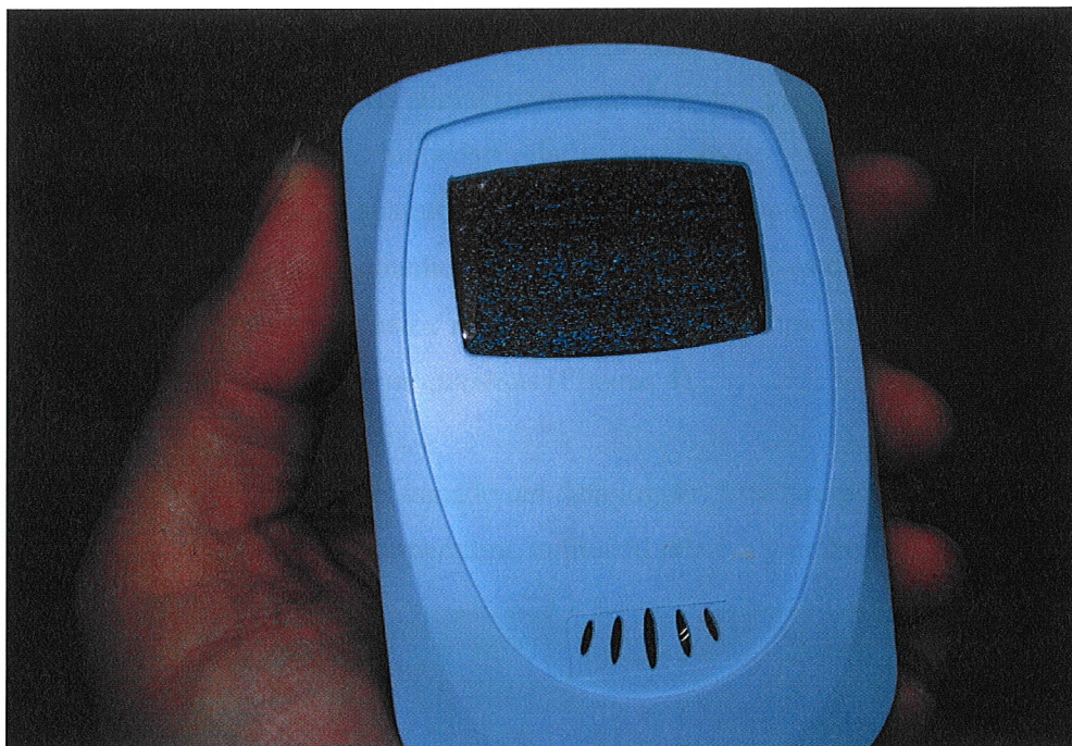
Figura 3. Receptor de Cámara con pantalla a color, parlante y audífonos. Este receptor mostraba la imagen del individuo o sus sonidos dentro de la cueva
