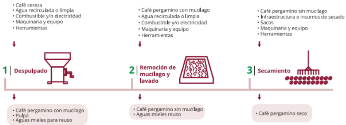
Figura 4: Representación del proceso de obtención de café pergamino mostrando las entradas y salidas en cada paso del proceso según el proceso húmedo de producción de café.
