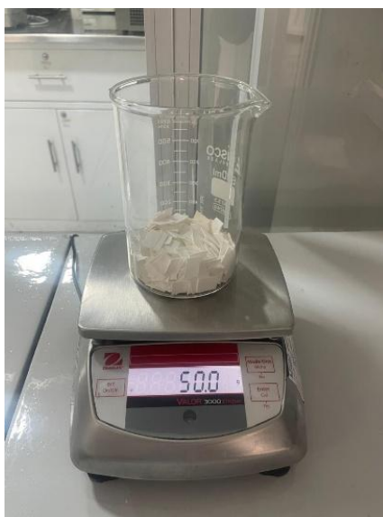
Figura 60. Muestra de HDPE cortado a emplear para la experimentación
