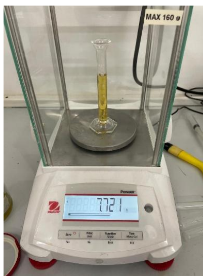
Figura 66. Determinación de densidad de producto líquido de pirólisis
