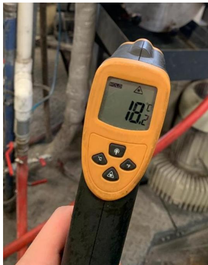
Figura 62. Medición de temperatura con termómetro láser
