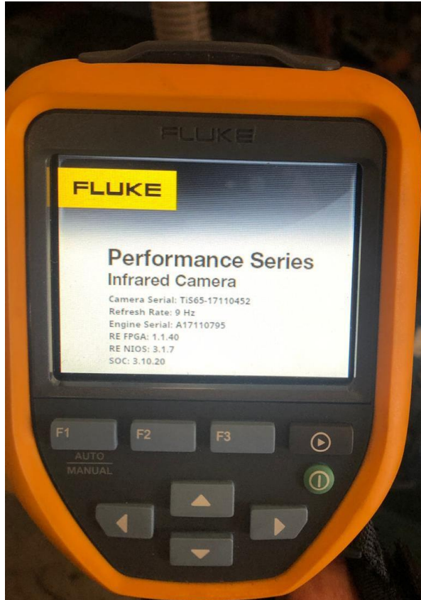
Figura 54. Cámara termografía utilizada para el estudio
