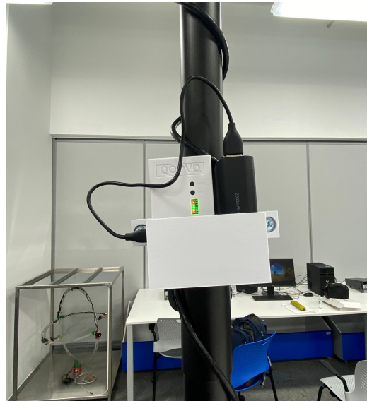
Figura 64: Agarrador instalado con módulo y batería portátil visto de enfrente
