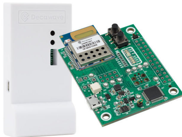
Figura 20: Módulos MDK1001 - DEV de la empresa Qorvo utilizados en el trabajo [10]
