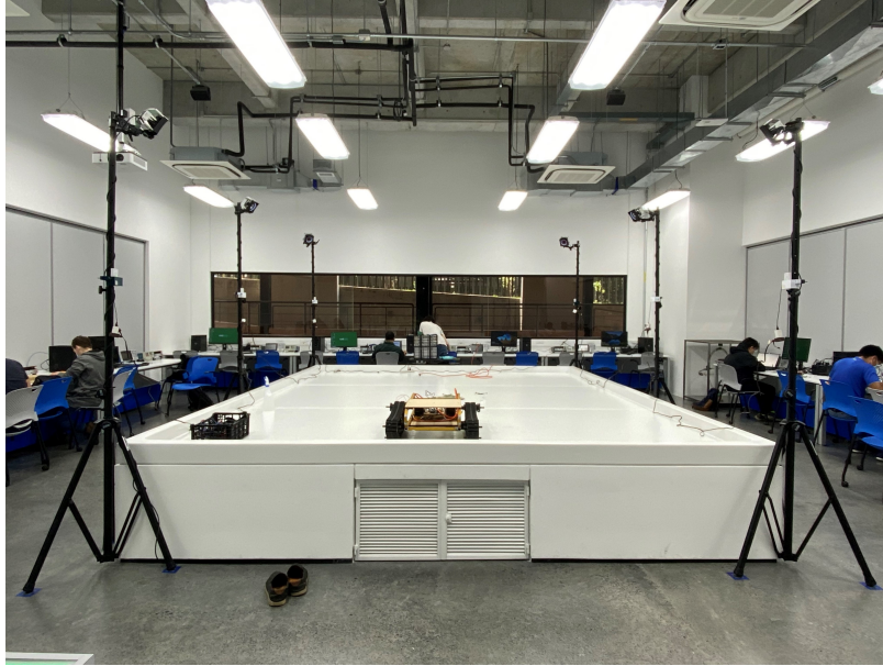
Figura 79: Montaje de los módulos en prueba de comparación con OptiTrack
