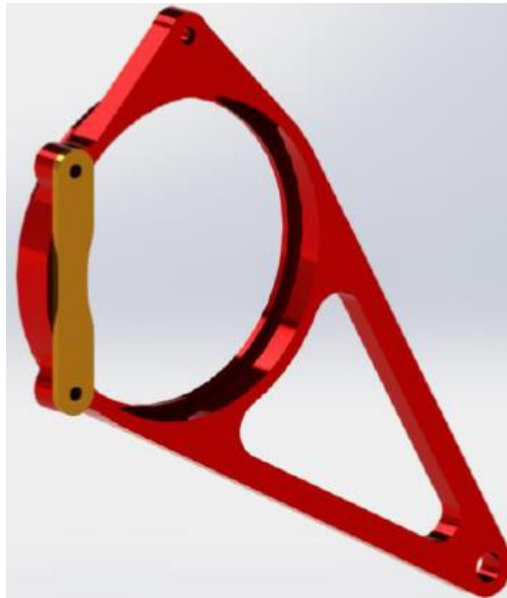
Figura No. 8: Soporte de equipo UPS Racing team con barra lateral para ajuste de rodamiento.
