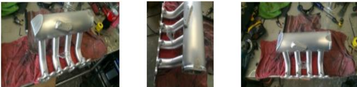
Figura No. 51: Múltiple de admisión hecho por medio de tubería.
