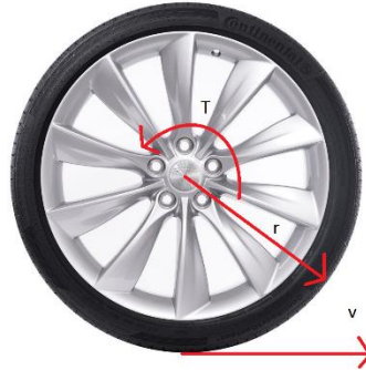
Figura No. 22: Diagrama de cuerpo libre neumático
