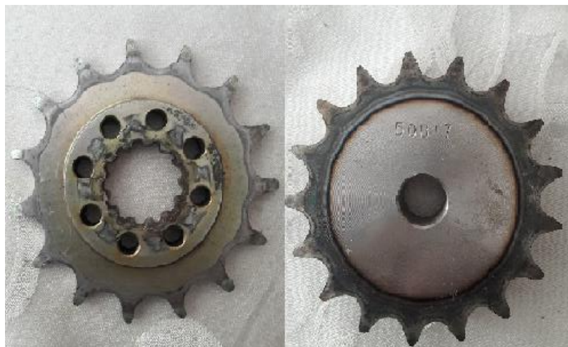
Figura No. 157. Ranura de piñón para Suzuki GXSR 600 comparada con ranura nominal de piñón Katayama
