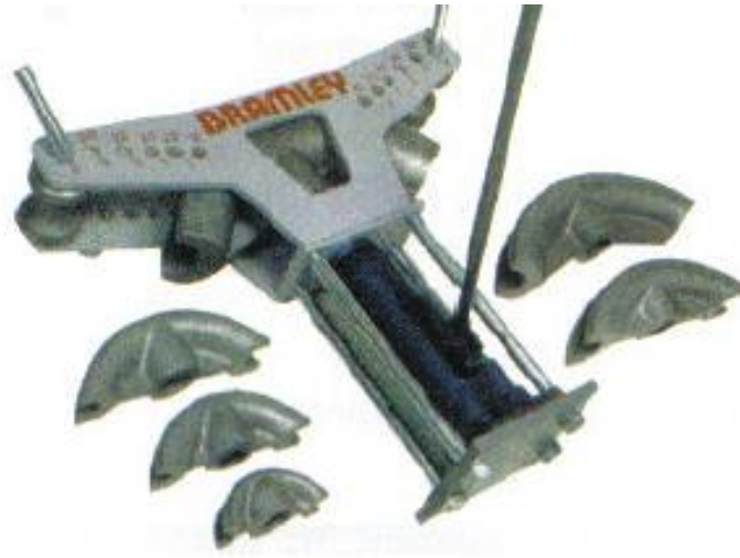
Figura No. 30 Dobladora de tubos.
