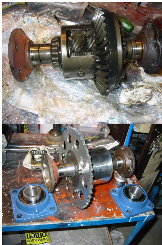
Figura No. 3: Diferencial torsen Audi V8 1992 en estado inicial vs adaptación para funcionamiento a base de cadena y engrane
