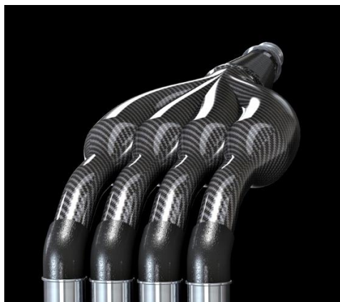
Figura No. 50: Múltiple de admisión hecho por medio de compuestos de fibra.
