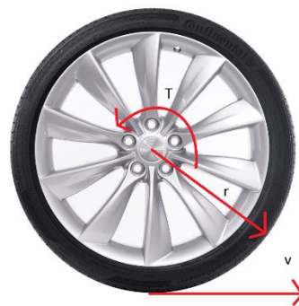
Figura No. 76: Análisis de relación entre el radio y la velocidad del neumático.
