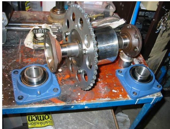
Figura No. 35: Catalina exterior adherida al diferencial de equipo MRIDE C42 turbo sportscar.
