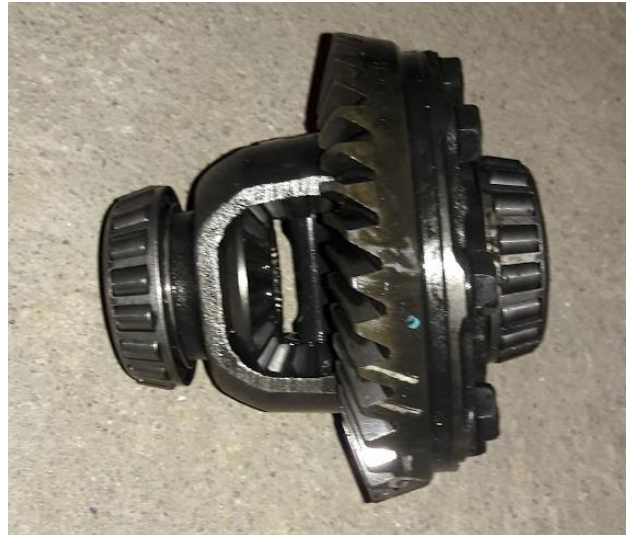
Figura No. 33: Diferencial Subaru WRX con sus rodamientos cónicos y anillo exterior.
