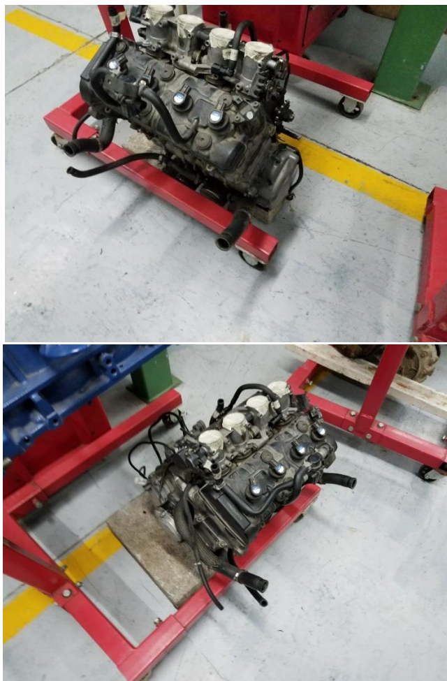
Figura No. 155: Vista del motor ya desmontado con el arnés eléctrico desconectado y sus cilindros protegidos a agentes externos.
