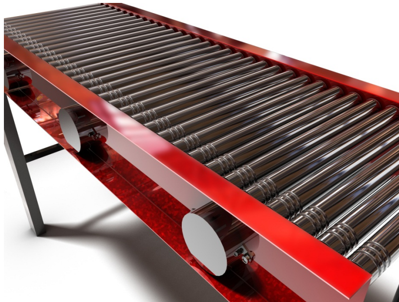
Figura No. 55 Montaje de motores en la transportadora.
