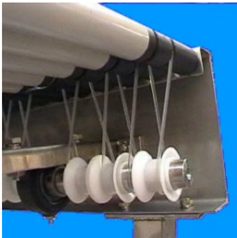
Figura No. 7 Transportadora de rodillos accionada por medio de eje y poleas. [5]
