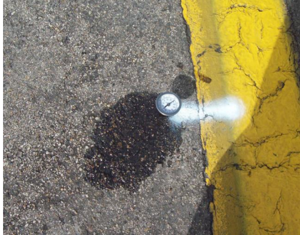
Ilustración 25. Medición de temperatura de asfalto.
