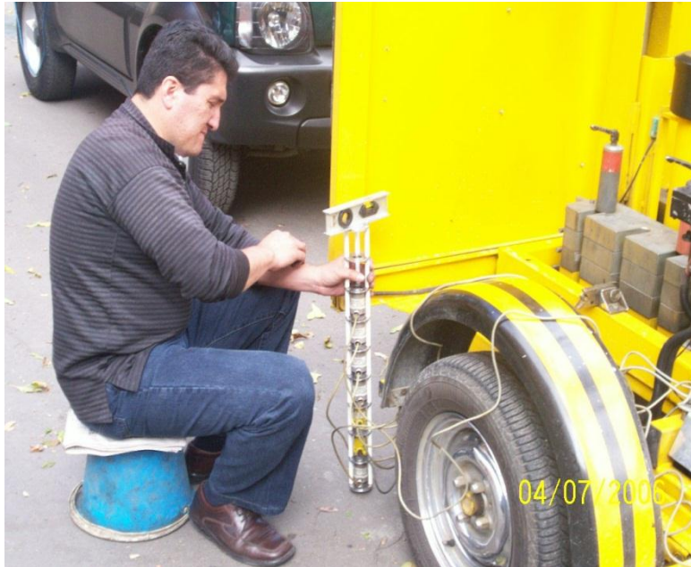
Ilustración 21. Calibración Relativa de Geófonos.
