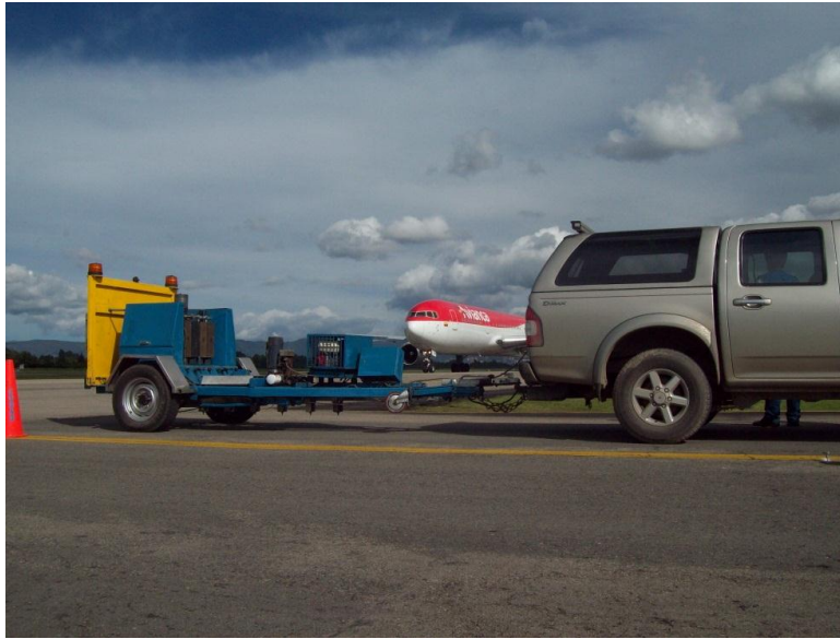
Ilustración 19. Deflectómetro de Impacto "Heavy" utilizado en Aeropuertos.
