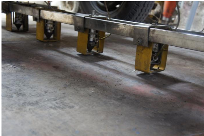
Ilustración 18. Sensores (Geófonos) que registran las deflexiones en el FWD.
