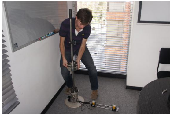
Ilustración 20. Deflectómetro de Impacto "Light" utilizado a nivel de base.
