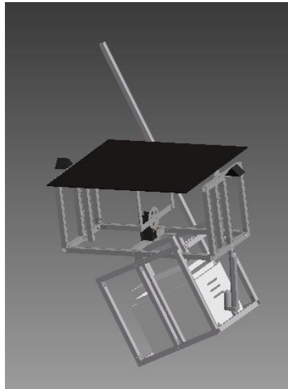
Figura 72- Diseño final de estructura para estación meteorológica
