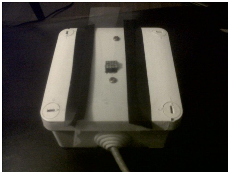
Figura 92- Sensor TSL23RD (Radiación solar)
