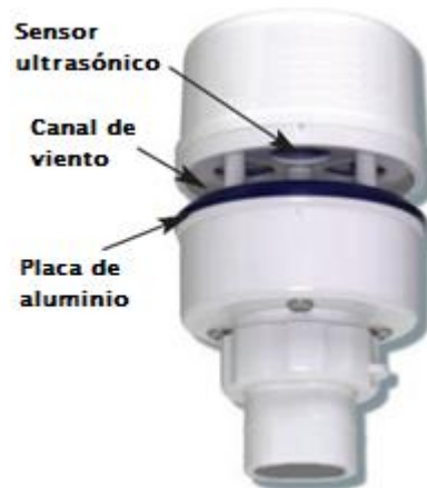
Figura 5: Dispositivo NM150 y ubicación de partes para la medición de viento
