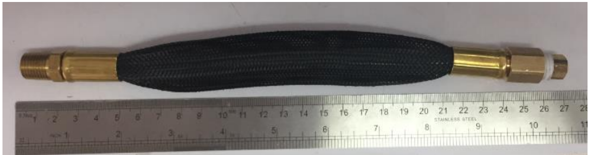
Figura 469. Actuador neumático flexible de 0.25\text{ m} .
