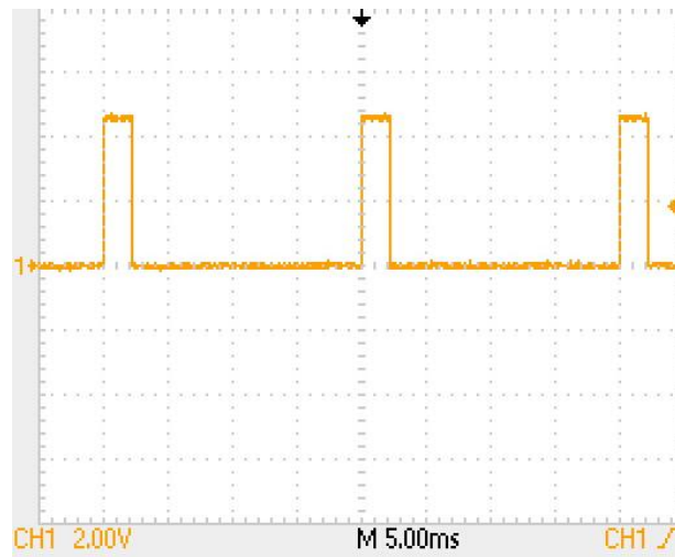
Figura 424. Señal de control original para servos comunes
