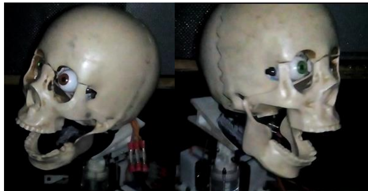
Figura 222. Pruebas de movimiento del cuello.
