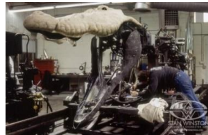
Figura 23. Mandíbula de un cocodrilo animatrónica, accionada por actuadores neumáticos.
