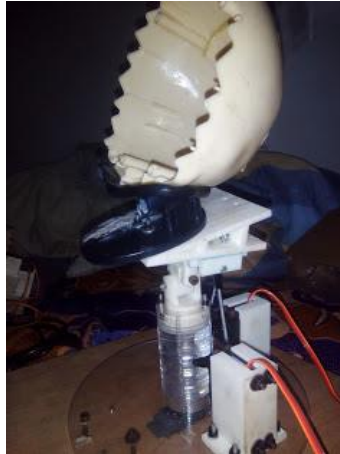
Figura 212. Mecanismo del cuello luego de ser ensamblado con la parte trasera del cráneo.
