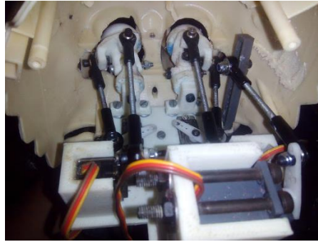
Figura 209. Mecanismo de ojos y boca ensamblados, vista superior.
