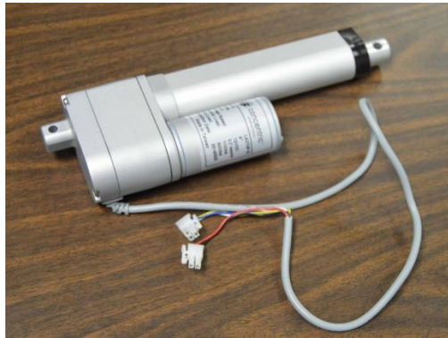
Figura 218. Actuador lineal utilizado para levantar la calavera del cofre.
