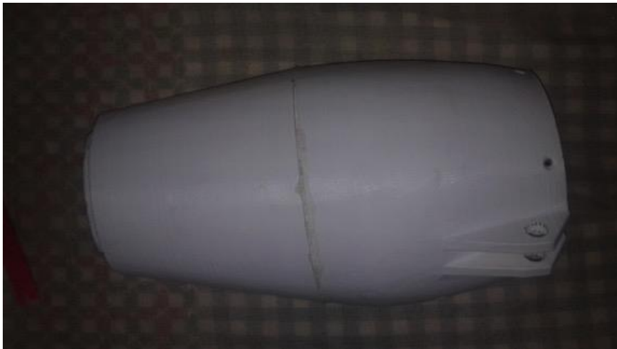
Figura 356. Unión con pegamento de Robpart3 con Robpart4.
