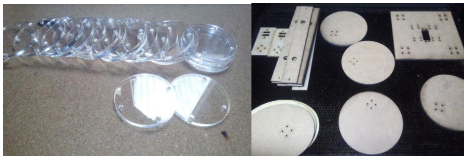
Figura 199. Piezas realizadas con corte láser.
