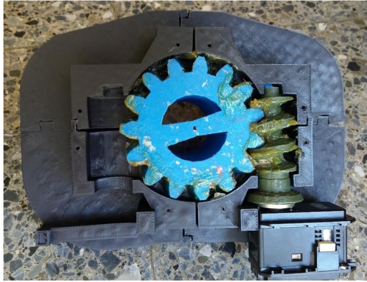
Figura 298. Montaje de mecanismo tornillo sinfín y engranaje
