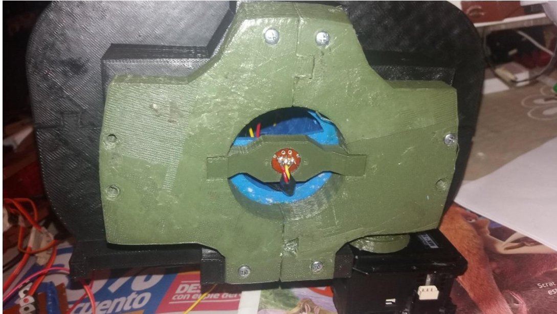
Figura 316. Potenciómetro insertado en el eje para medir rotación del torso
