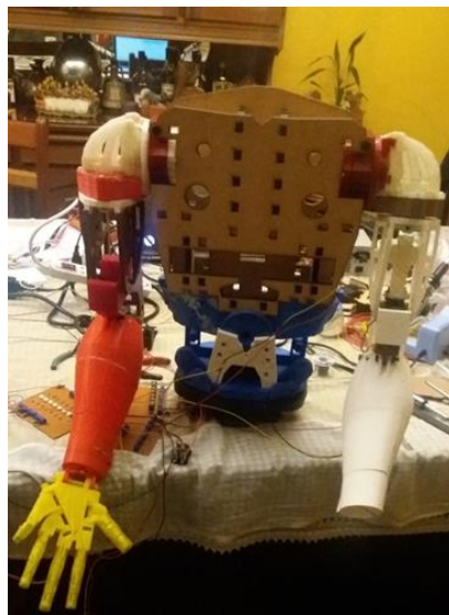
Figura 398. Brazos y torso ensamblados.
