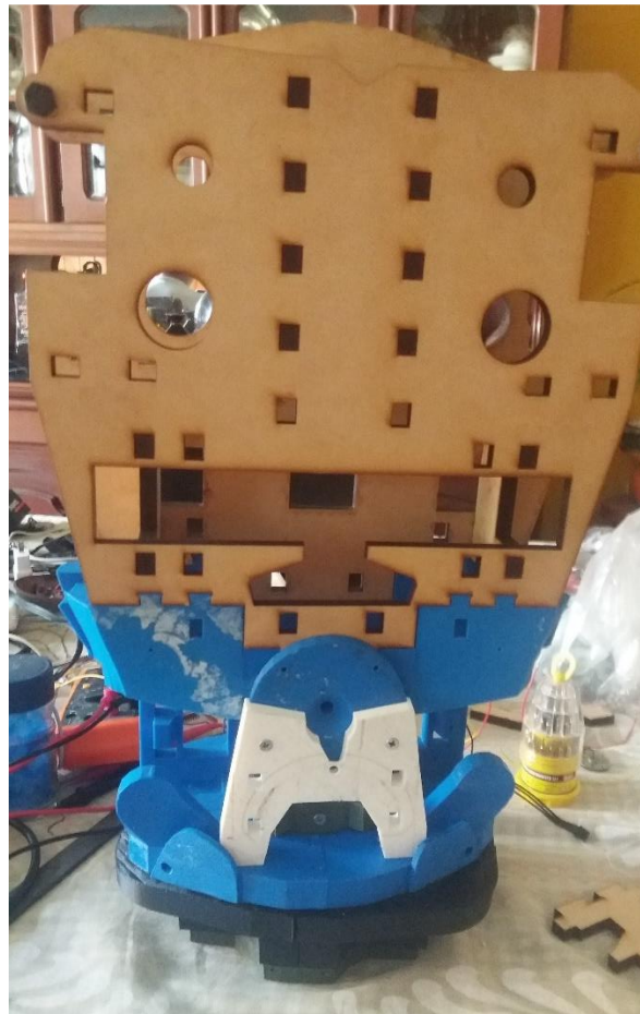
Figura 314. Ensamble completo del torso animatrónico
