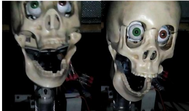
Figura 221. Pruebas de movimiento del cuello.
