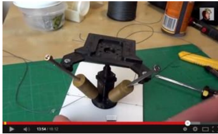
Figura 161. Mecanismo de cuello diseñado por James Bruton. 7
