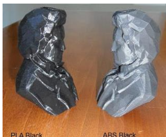
Figura 54. Comparación de acabados entre ABS y PLA
