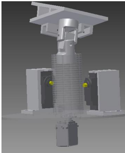
Figura 180. Mecanismo final de movimiento del cuello.
