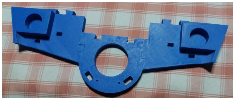
Figura 303. Conexión estómago superior- torso
