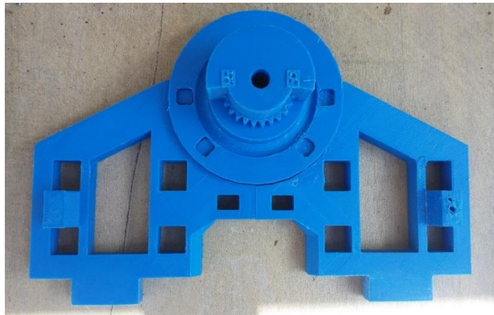
Figura 301. Soporte trasero del estómago superior
