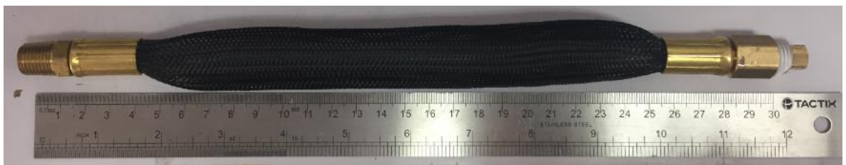
Figura 469. Actuador neumático flexible de 0.25\text{ m} .
