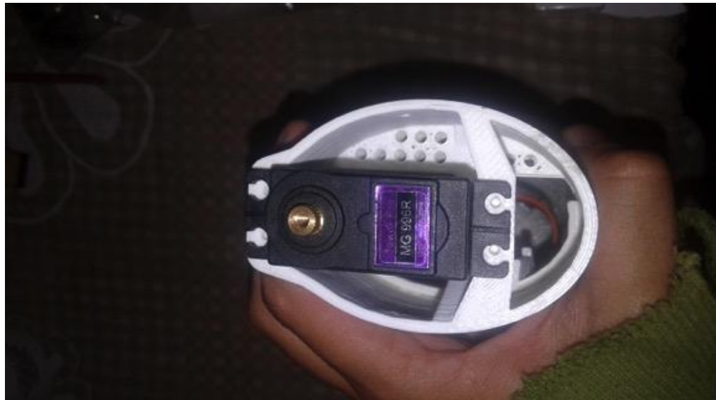
Figura 360. Servomotor para mecanismo de muñeca
