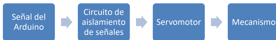
Figura 256. Diagrama de bloques del sistema de control del proyecto.
