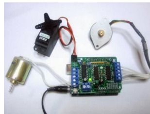
Figura 29. Ejemplos de motores eléctricos.
