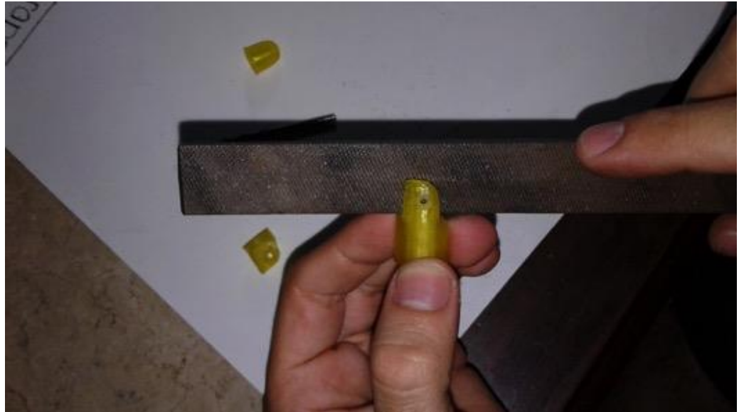
Figura 366. Limar piezas antes de ensamblar.
