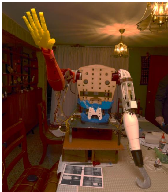
Figura 401. Integración de módulo de control, reconocimiento de gestos y audio, torso y brazos
