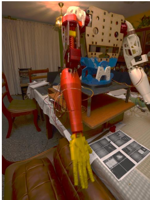
Figura 393. Codos en posición de extensión.
