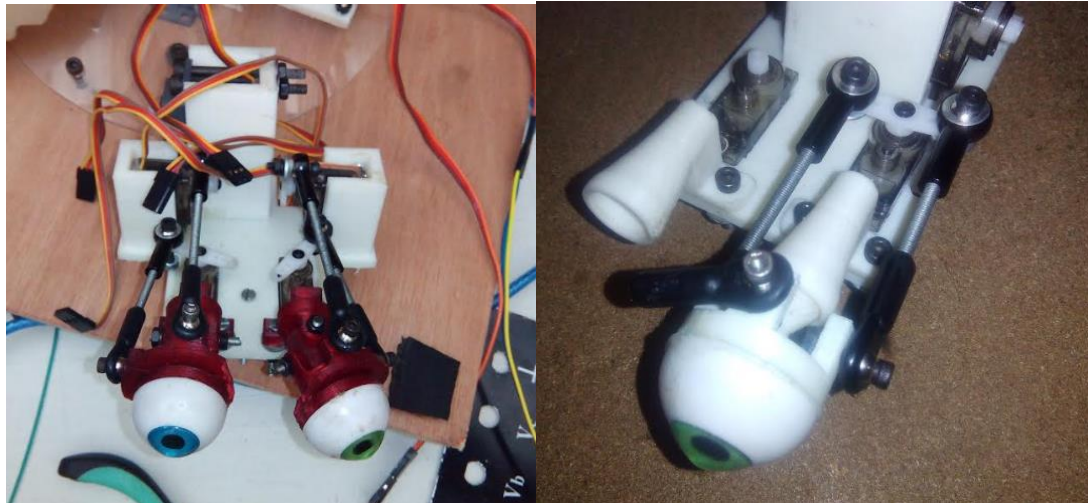
Figura 201. Comparación entre piezas de PLA (rojas) y piezas de ABS (blancas)
