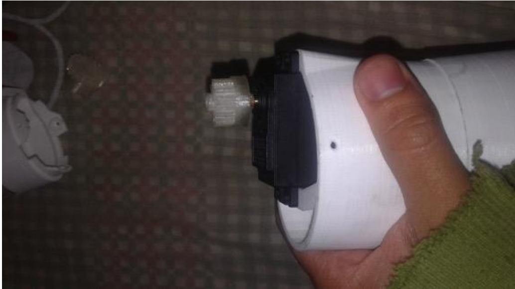
Figura 361. Engrane para mecanismo de muñeca
