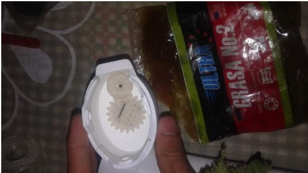
Figura 362. Engrasar mecanismo de muñeca antes de ensamblar.
