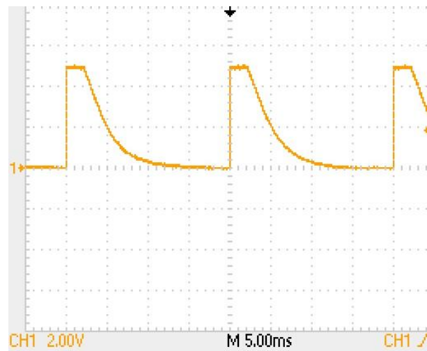
Figura 425. Señal de control aislada para servos comunes
