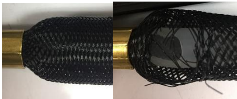
Figura 475. Actuador de 0.15 m, antes y después, de fallar a 480kPa (70 psi).
