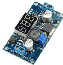
Figura 42. Módulo de regulación de voltaje, utilizando el integrado LM2596.
