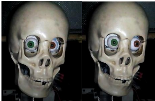
Figura 224. Pruebas de movimiento de los ojos
