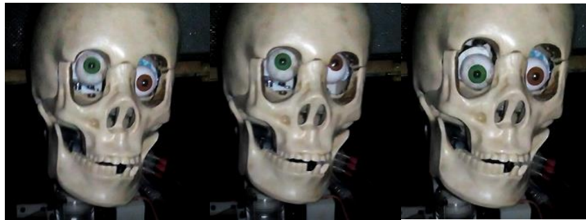
Figura 225. Pruebas de movimiento de los ojos
