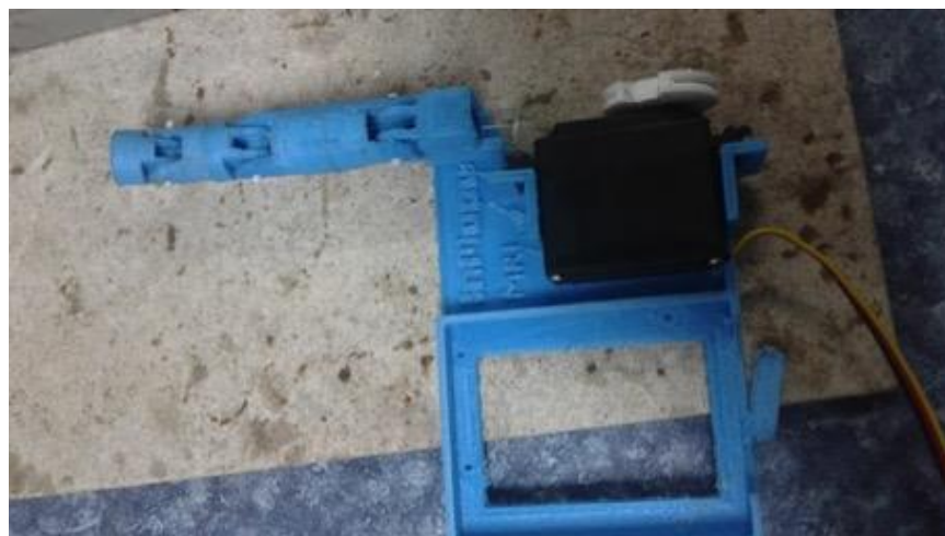
Figura 331. Mecanismo de dedo extendido con hilo de pescar de 0.5 mm de grosor.
