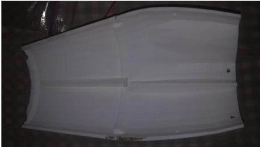
Figura 355. Unión con pegamento de Robpart2 con Robpart5.
