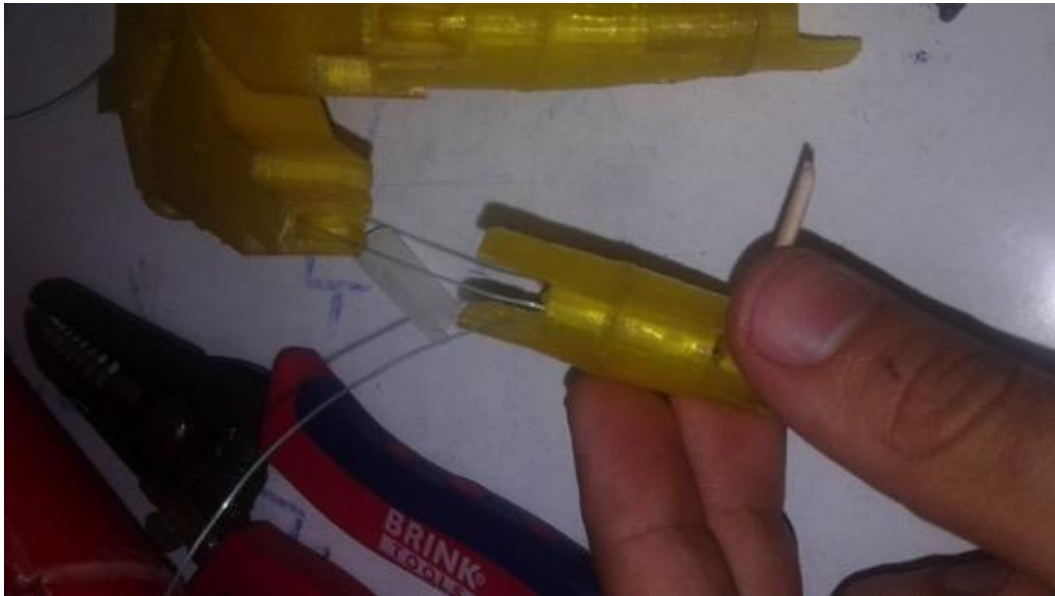
Figura 374. Ensamble de hilo de pescar con mano.
