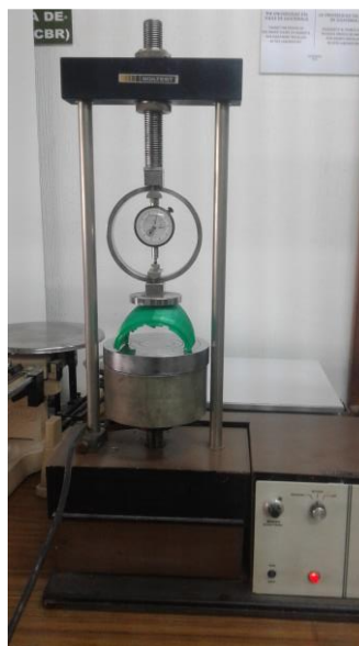
Figura 351. Equipo Soiltest para pruebas de materiales.
