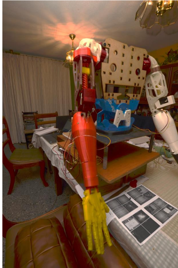
Figura 397. Hombros en posición de flexión.
