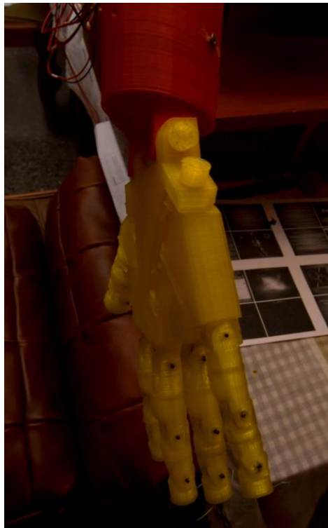
Figura 453. Muñeca derecha rotada a 180°
