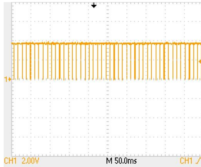
Figura 426. Señal de control original para motores Dynamixel
