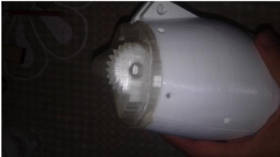
Figura 358. Unión de RobCap con ShaftGear y las piezas Robpart2 – Robpart5.
