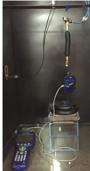
Figura 471. Configuración de un actuador neumático flexible para mediciones de fuerza.
