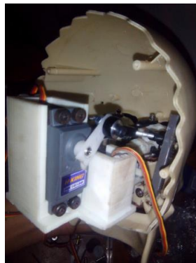
Figura 208. Mecanismo de ojos y boca luego de ser ensamblados, vista lateral.
