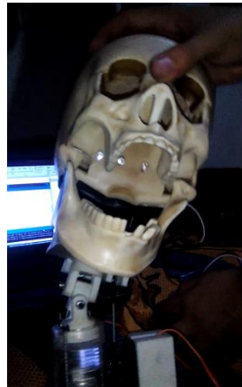
Figura 213. Mecanismo del cuello luego de ser ensamblado con la cabeza de la calavera.
