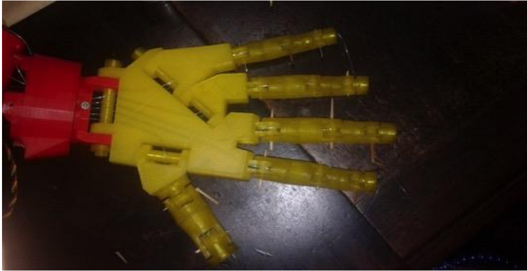
Figura 377. Ensamblaje de mano completa con hilos de pescar.
