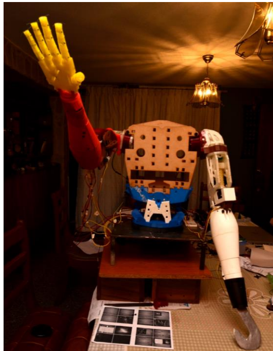
Figura 450. Hombro derecho arriba, codo derecho contraído
