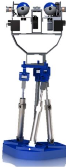
Figura 153. Mecanismo de cuello y ojos luego de ser ensamblados.
