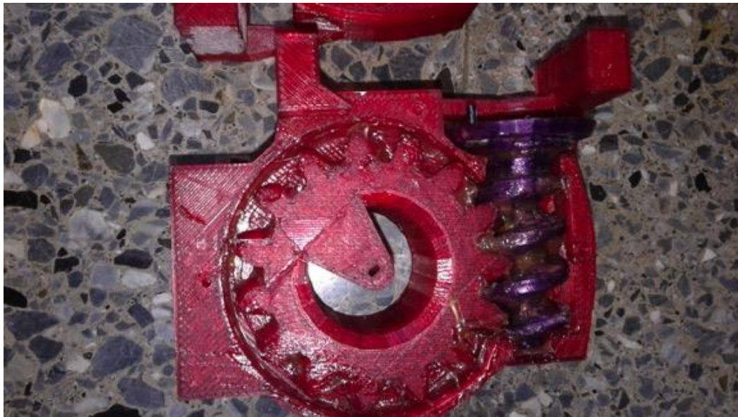
Figura 387. Mecanismo del hombro con grasa.
