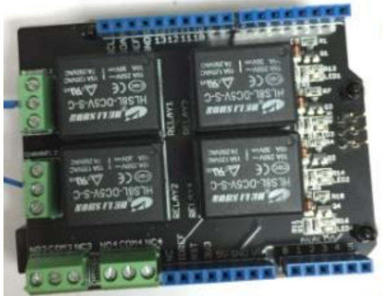
Figura 137. Escudo de relevadores para la protección del microcontrolador.
