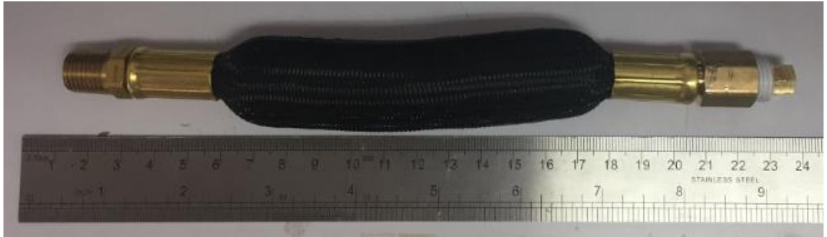
Figura 468. Actuador neumático flexible de 0.20\text{ m} .
