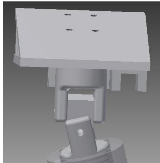
Figura 178. Unión universal utilizada para realizar el movimiento del cuello.
