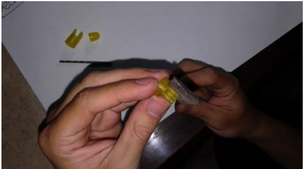
Figura 366. Limar piezas antes de ensamblar.
