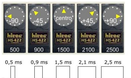
Figura No. 9 Ejemplos de señal PWM para controlar un servomotor [6]
