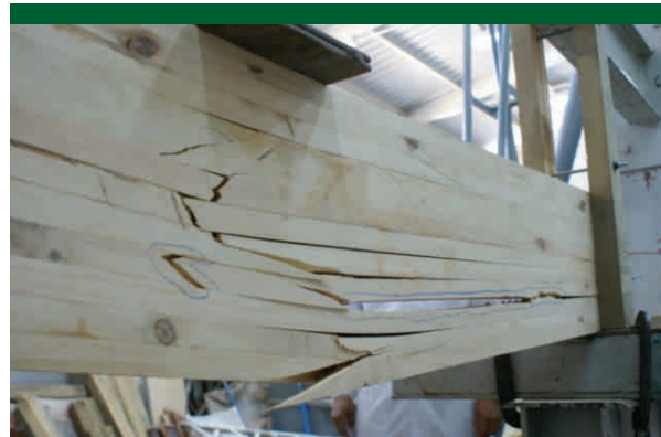
Gráfica 7. Ruptura típica por flexión (3.).
