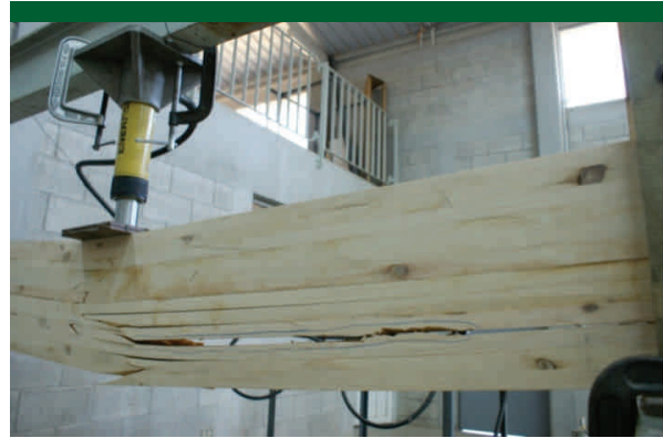
Gráfica 6. Ruptura típica por flexión (2).
