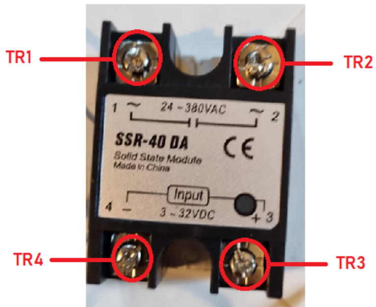
Figura 9. Terminales relé de estado sólido
