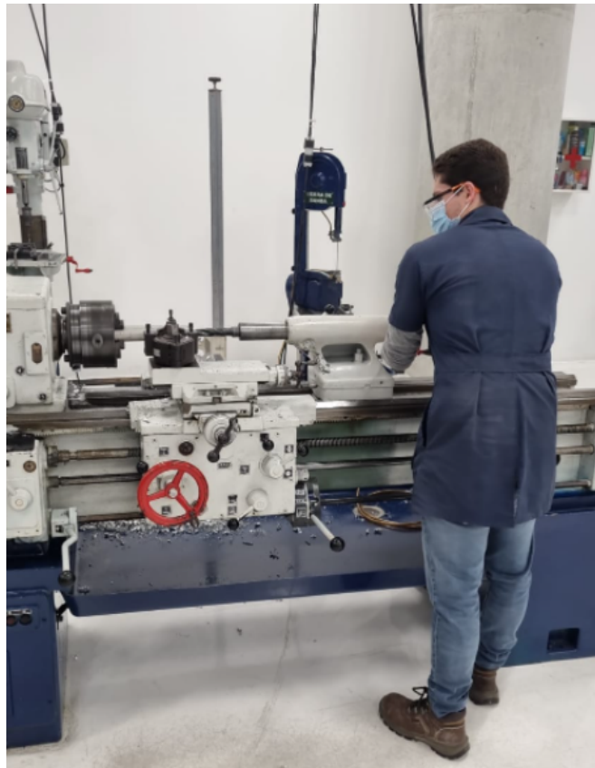
Figura 25: Maquinado en torno convencional de los tramos de barra redonda de 1-3/4"
