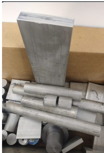
Figura 22: Material cortado previo a maquinar
