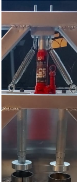
Figura 37: Sistema de compresión instalado en la máquina (a)
