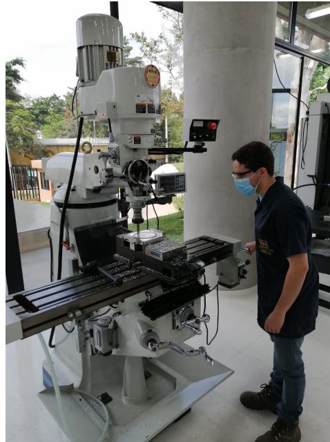
Figura 23: Fresado del tramo de barra rectangular de 1" x 4"
