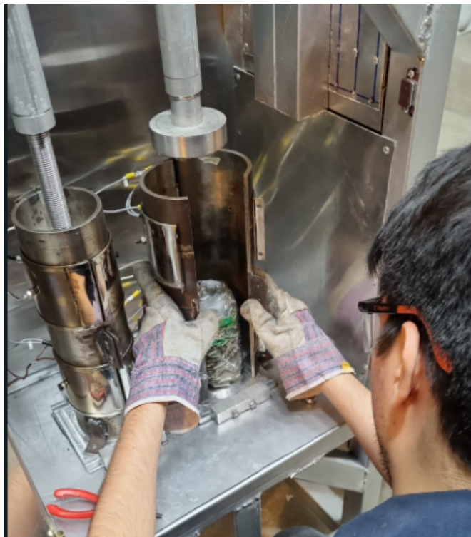
Figura 14. Separación de molde para retiro de plástico
